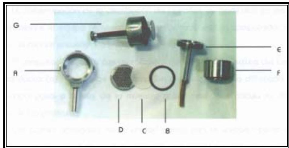
Figura N° 19. Piezas de la base de la celda
