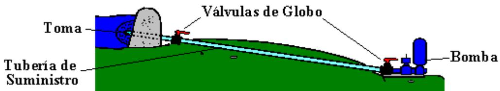
Figura N° 23 Tubería de Suministro
