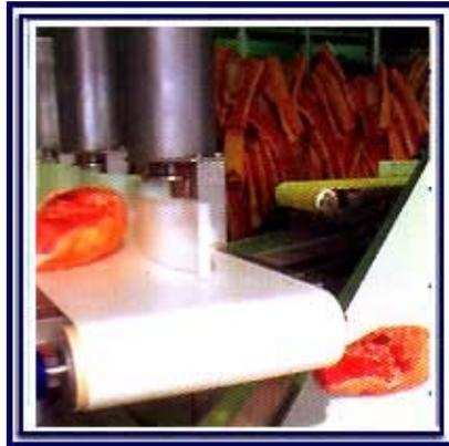
Figura 82. Banda Sanitaria Tipo Saniwhite.
