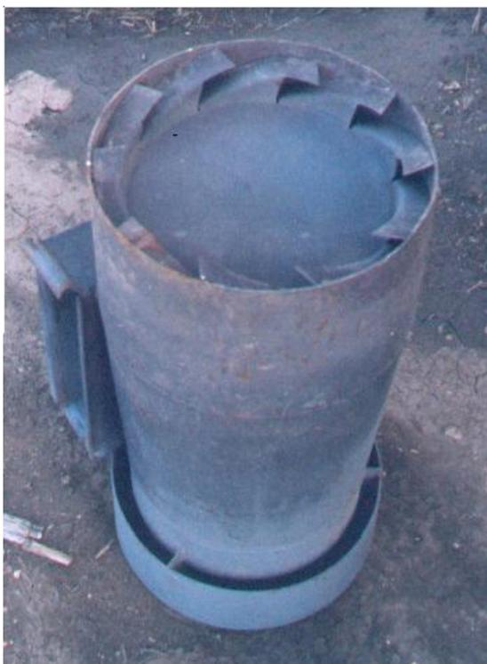
ciclónico, se presentan dos fotografías tomadas en el Central El Palmar S.A. a uno de estos elementos antes de ser colocado dentro del domo superior.
