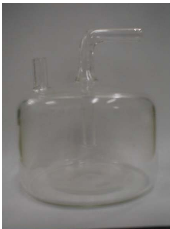
Figura 17. Trampa de Vapor
