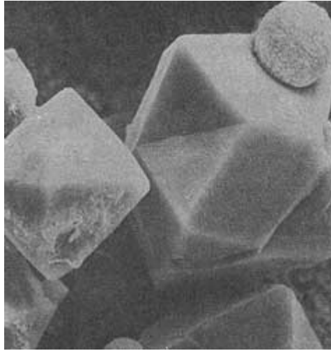
Figura 3. Zeolita faujasita X observada en el microscopio electrónico de barrido. Los cristales son de 50 m aproximadamente. Las partículas esféricas son de zeolita P.
