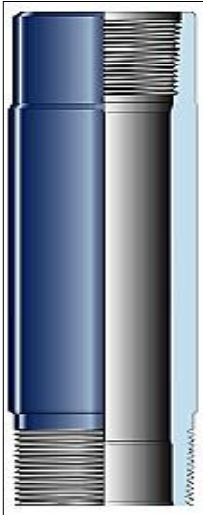
Figura 11 Junta de impacto [16]
