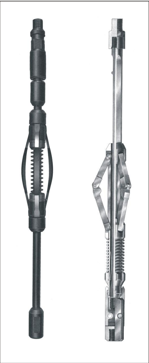
Figura 19 Herramienta de flexibilidad [1]
