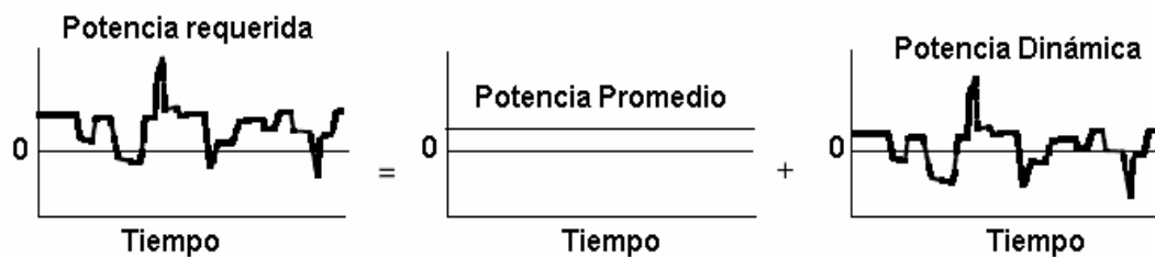
Figura 1. Potencia requerida para la propulsión descompuesta en componente estable y dinámica. El gráfico es una adaptación del mostrado en Modern electric, hybrid electric and fuel cell vehicles . (p. 120) por Ehsani, M., Gao, Y., Gay, S. E. y Emadi, A., 2002, Florida: CRC Press.
