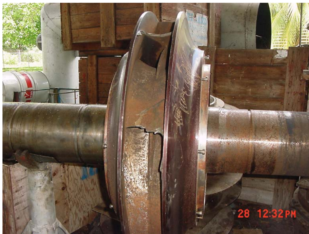
Foto 8 Falla del rodete de la bomba de E/B 31
