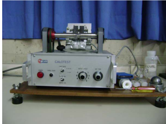
Figura N° 2.11. Equipo de Calotest.
