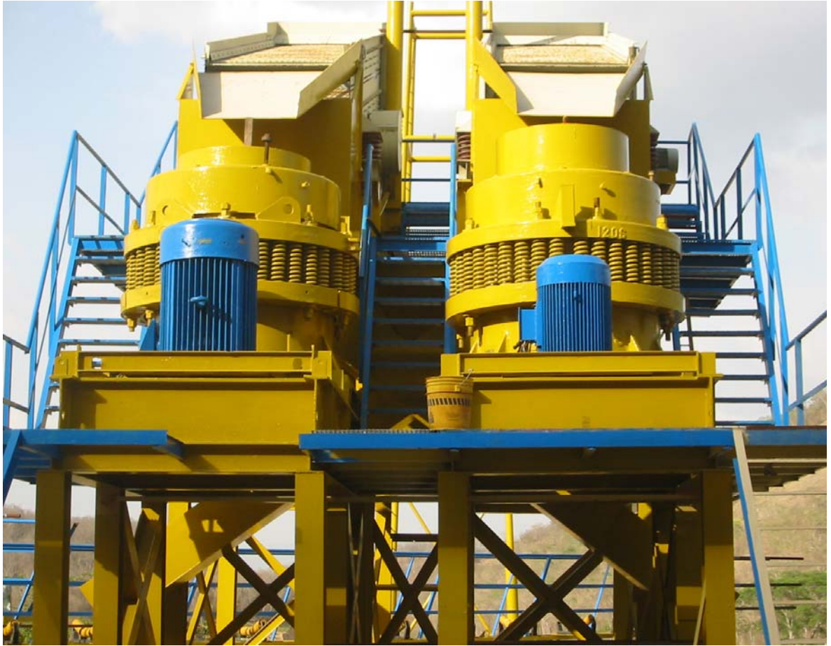
Foto V-06: Trituradores de cono terciario
