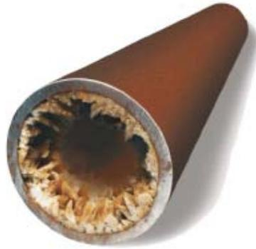
Figura 4.8 Envejecimiento de las tuberías
