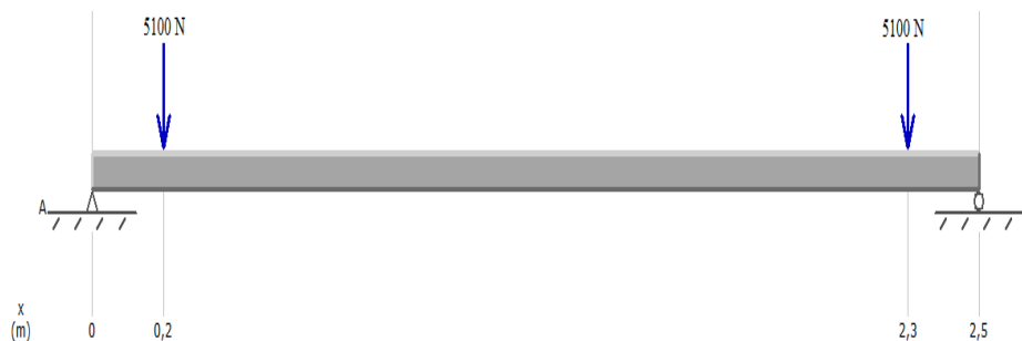
Figura 3.17: Esquema de fuerzas concentradas sobre el eje del cilindro.
