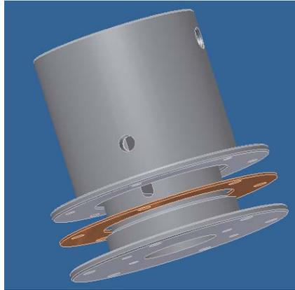
**Figura 5. 1.** Colocación del papel de empacadura.
