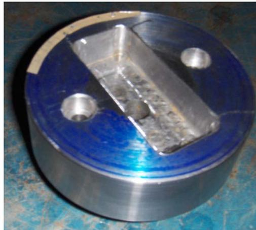
**Figura 4. 28.** Cavidad mecanizada por fresado.
