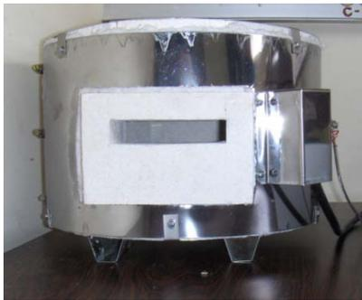
**Figura 4. 12.** Horno de precalentamiento
