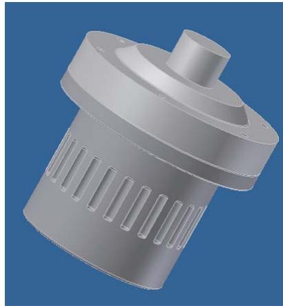
**Figura 3. 16.** Ensamble de la propuesta 2 para la base refrigerada.
