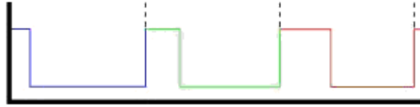
Figura N° 38: Modulación de Ancho de Pulso para el servomotor.
