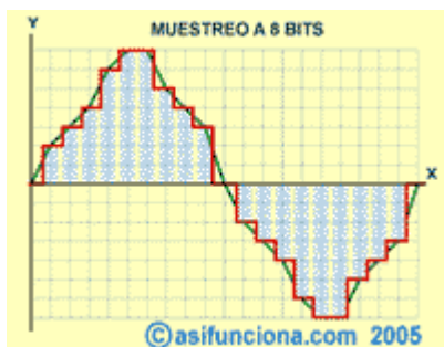
FIGURA 3: MUESTREO DE UNA SEÑAL DIGITALIZADA A 8 BITS
