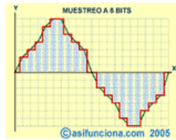
Figura N° 23: Gráfica de digitalización de una señal de 8 bits.
