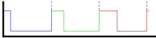
FIGURA 2: MODULACIÓN DE ANCHO DE PULSO DE UN SERVOMOTOR PARA TODO SU RANGO DE FUNCIONAMIENTO
