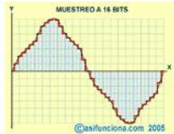
Figura N° 24: Gráfica de digitalización de una señal de 16 bits.
