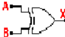
Figura N° 17: Símbolo de una compuerta XOR.
