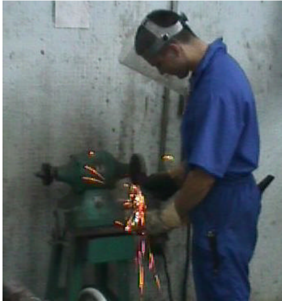
Figura N° 12.5.4. Esmeril de banco, modelo BOEHRINGER, Alemania.
