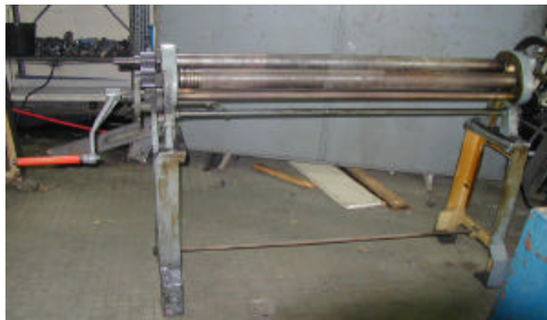
Figura N° 12.5.3. Máquina cilindradora manual, modelo Vallotti, Italia..
