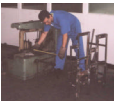
Figura N° 12.1.1. Máquina cortadora de Metal tipo vaivén con segueta 12", modelo REMAC, marca Olivetti, N° 300, Milano Italia.
