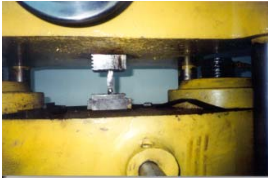
Figura 3.4.- ENCUELLAMIENTO DE LA PROBETA DE TRACCIÓN SUPERIOR
