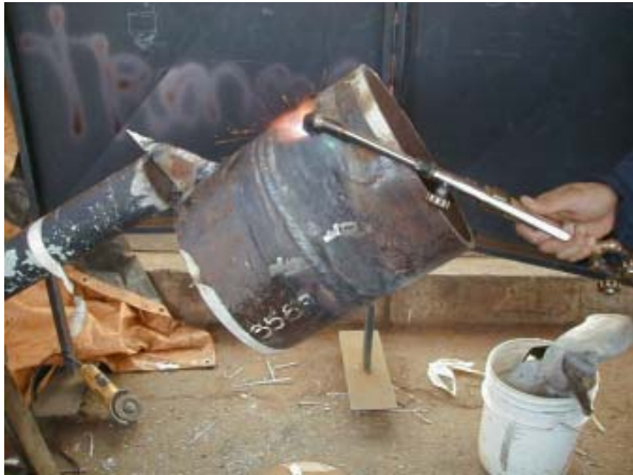
Figura 2.11.- MANTENIMIENTO DE LA TEMPERATURA ENTRE PASES
