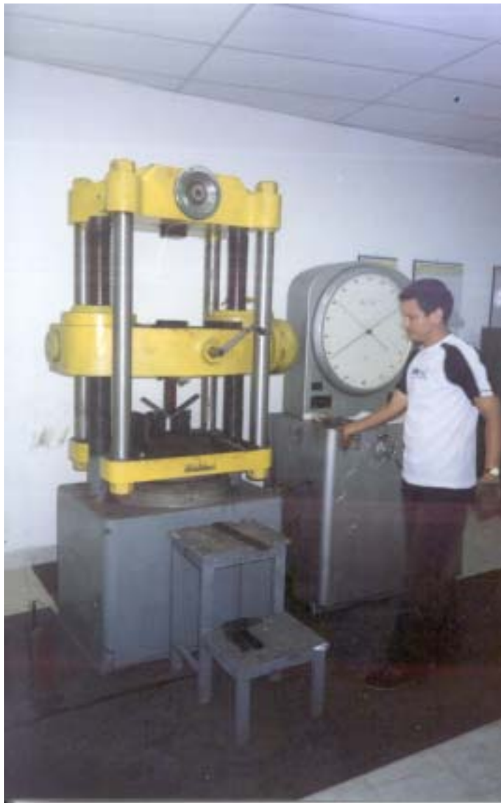
Figura 2.21.- MÁQUINA DE ENSAYO UNIVERSAL USADA PARA REALIZAR LOS ENSAYOS DE DOBLADO.
