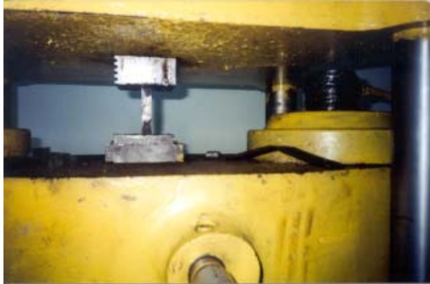
Figura 3.5.- ENCUELLAMIENTO DE LA PROBETA DE TRACCIÓN INFERIOR
