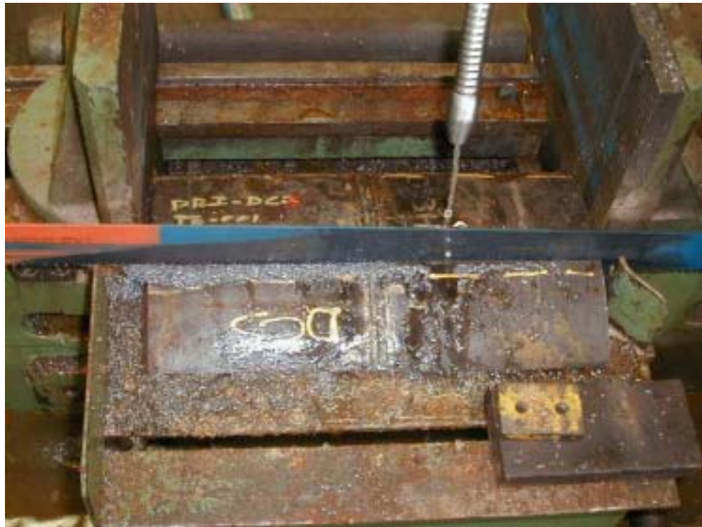
Figura 2.15.- CORTE DE LAS TUBERÍAS PARA LA EXTRACCIÓN DELAS PROBETAS
