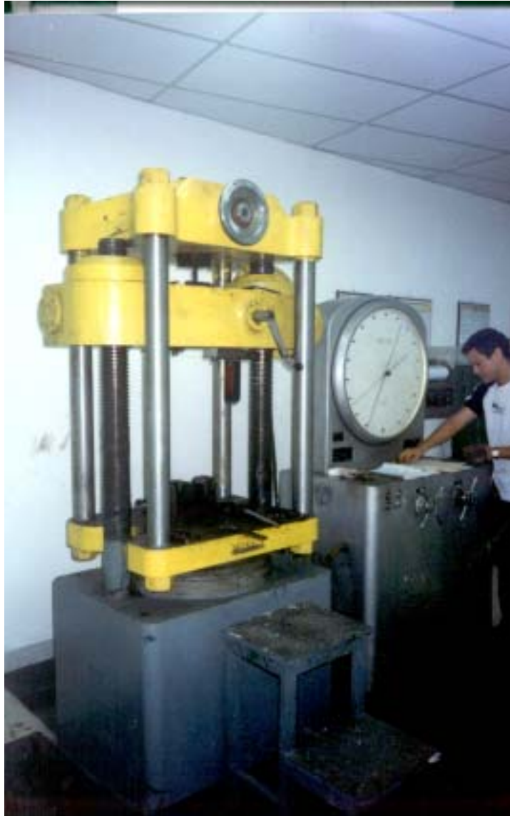
Figura 2.20.- MÁQUINA DE ENSAYO UNIVERSAL USADA PARA REALIZAR LOS ENSAYOS DE TRACCIÓN.
