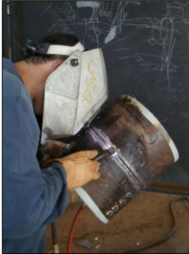
Figura 2.9.- PROCESO DE SOLDADURA GTAW
