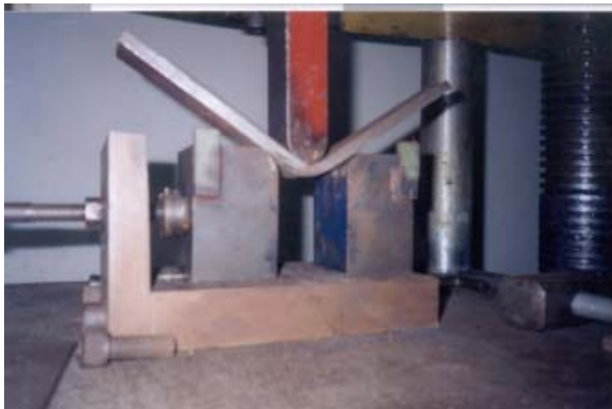
Figura 3.6.- MECANISMO DE DOBLADO DE LAS PROBETAS
