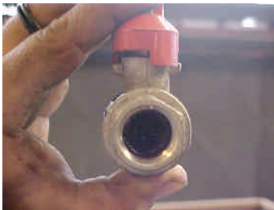
Figura 4.13 Orificio tapado totalmente en una llave de paso. ( f_N = 1^{1/2} " )
