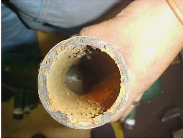
Fig. 4.10 Incrustaciones en la entrada de alimentación. ( f_N = 2'' )
