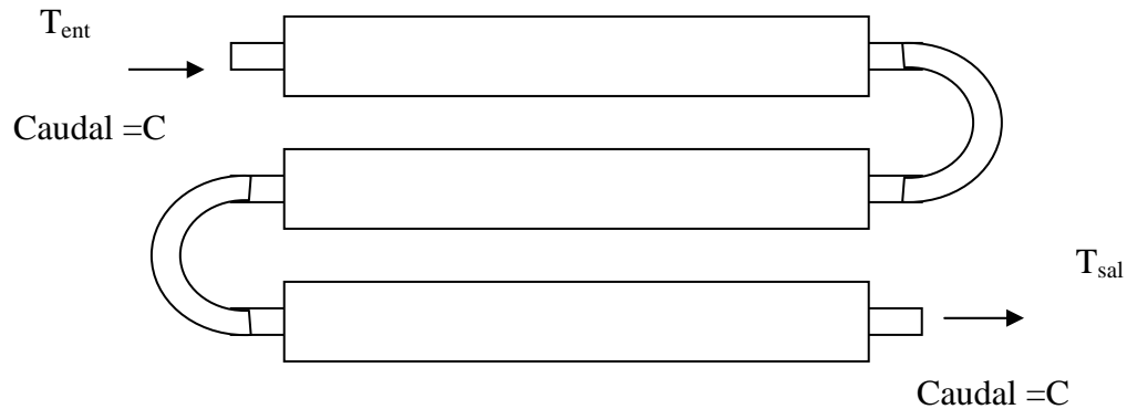
Fig. 4.43.-Intercambiador de calor actual (vista superior).
