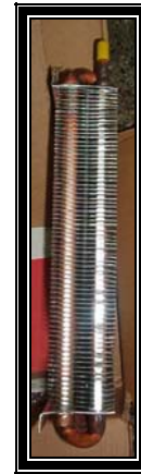
Fig.4.40.-Intercambiador de calor (vista lateral)
