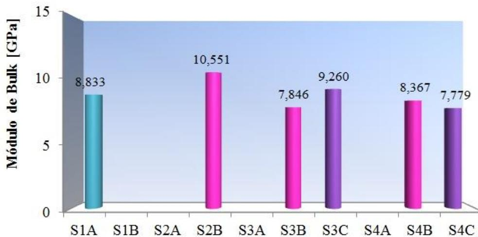
**Figura 5.133.** Gráfica Comparativa de los Resultados del Módulo de Bulk en el Ensayo Acústico para los diferentes Sistemas Cementantes Curados a 12 h.
