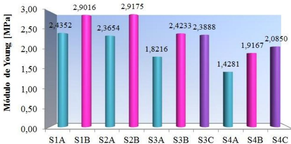
**Figura 5.105.** Gráfica Comparativa de los Resultados del Módulo de Young en el Ensayo Mecánico para los diferentes Sistemas Cementantes Curados a 48 h.
