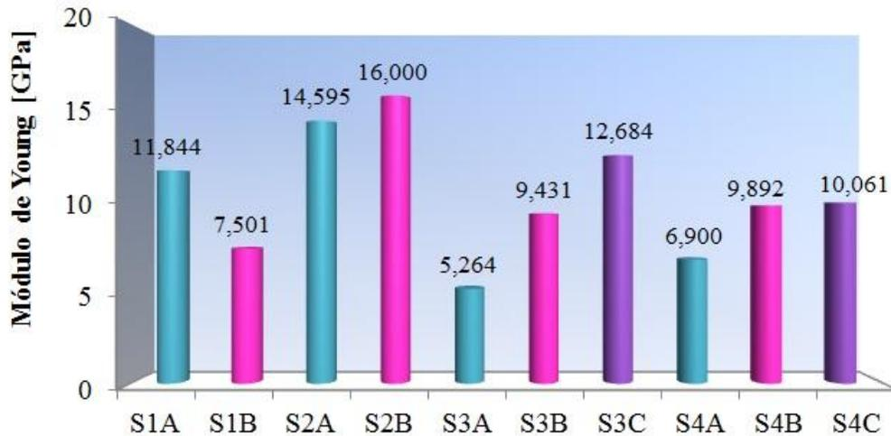
**Figura 5.130.** Gráfica Comparativa de los Resultados del Módulo de Young en el Ensayo Acústico para los diferentes Sistemas Cementantes Curados a 24 h.
