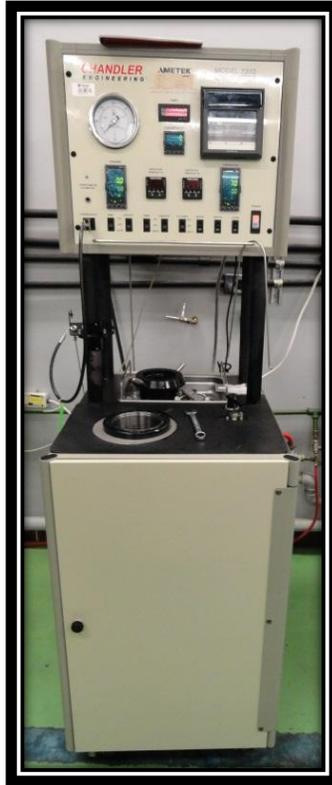
**Figura 4.4.** Consistómetro Presurizado Marca Chandler Engineering Modelo 7222.
