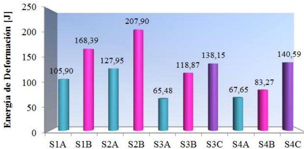
**Figura 5.111.** Gráfica Comparativa de los Resultados de la Energía de Deformación en el Ensayo Mecánico para los diferentes Sistemas Cementantes Curados a 24 h.
