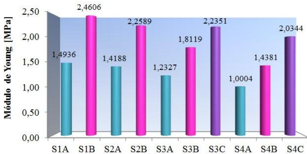
**Figura 5.104.** Gráfica Comparativa de los Resultados del Módulo de Young en el Ensayo Mecánico para los diferentes Sistemas Cementantes Curados a 24 h.
