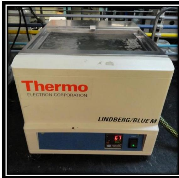
**Figura 4.6.** Cámara de Curado Atmosférica Marca Thermo Electron Modelo WB1110A-1.
