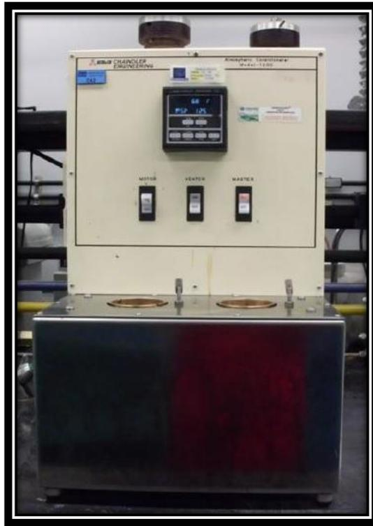
**Figura 4.3.** Consistómetro Atmosférico Marca Chandler Engineering Modelo 1200.
