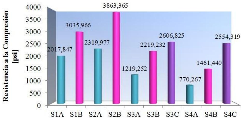
**Figura 5.96.** Gráfica Comparativa de los Resultados de la Resistencia a la Compresión en el Ensayo Mecánico para los diferentes Sistemas Cementantes Curados a 20 h.
