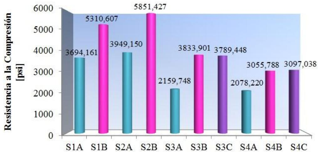
**Figura 5.98.** Gráfica Comparativa de los Resultados de la Resistencia a la Compresión en el Ensayo Mecánico para los diferentes Sistemas Cementantes Curados a 48 h.
