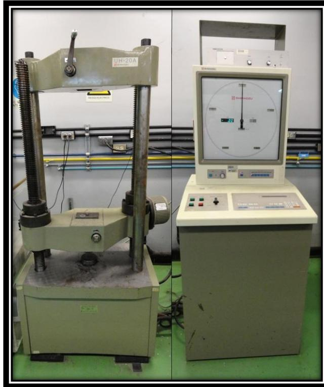
**Figura 4.8.** Prensa Mecánica Marca Shimadzu Modelo UH-20A.
