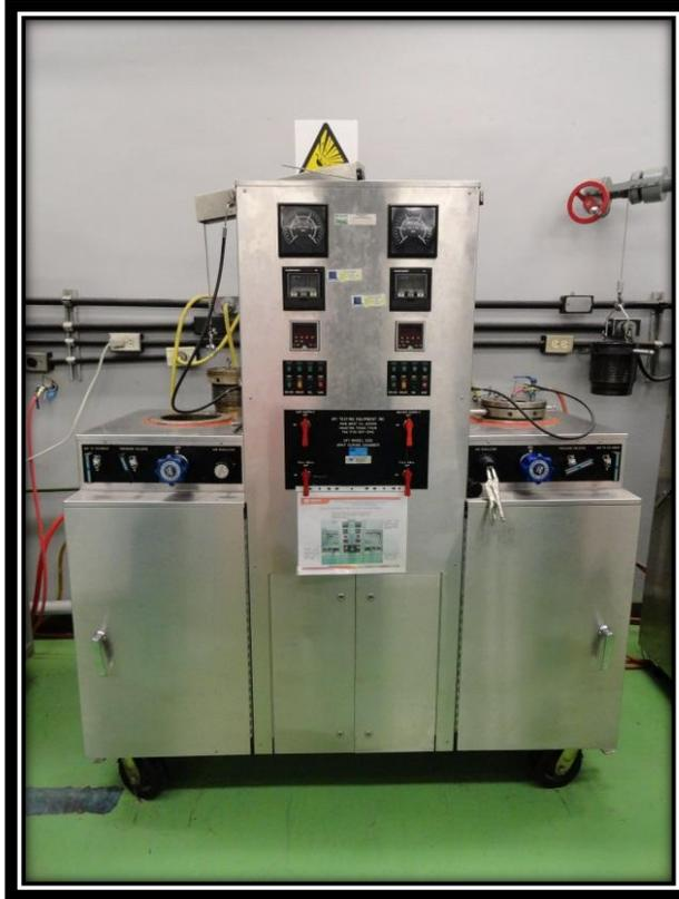
**Figura 4.7.** Cámara de Curado HPHT Marca OTI Modelo 200.
