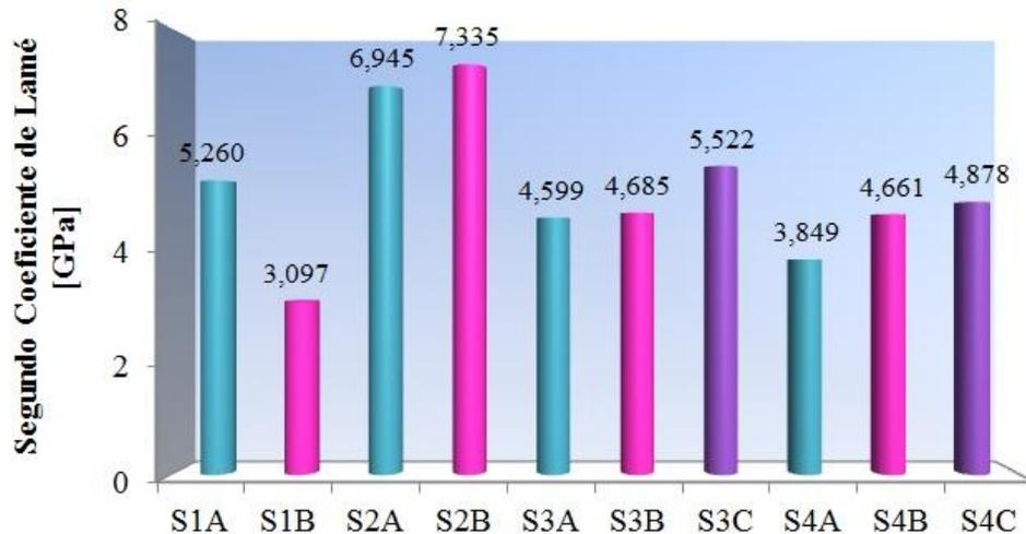
**Figura 5.149.** Gráfica Comparativa de los Resultados del Segundo Coeficiente de Lamé en el Ensayo Acústico para los diferentes Sistemas Cementantes Curados a 48 h.
