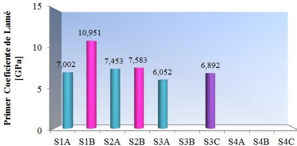
**Figura 5.140.** Gráfica Comparativa de los Resultados del Primer Coeficiente de Lamé en el Ensayo Acústico para los diferentes Sistemas Cementantes Curados a 16 h.
