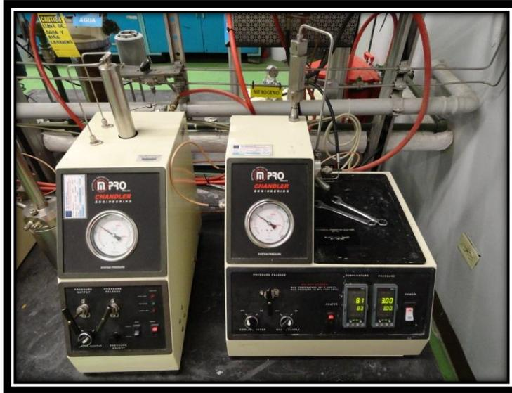
**Figura 4.9.** Analizador de Propiedades Mecánicas Marca Chandler Engineering Modelo 6265 MPRO.
