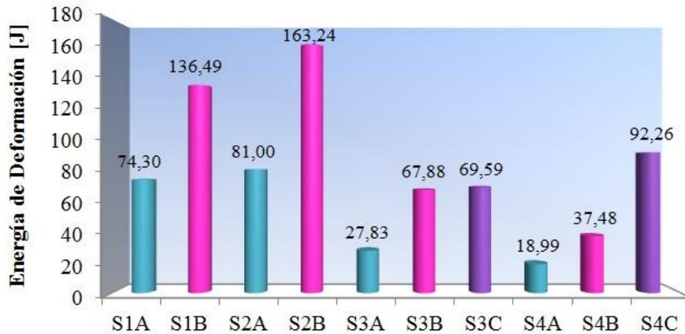
**Figura 5.109.** Gráfica Comparativa de los Resultados de la Energía de Deformación en el Ensayo Mecánico para los diferentes Sistemas Cementantes Curados a 16 h.
