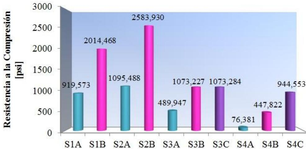
**Figura 5.94.** Gráfica Comparativa de los Resultados de la Resistencia a la Compresión en el Ensayo Mecánico para los diferentes Sistemas Cementantes Curados a 12 h.
