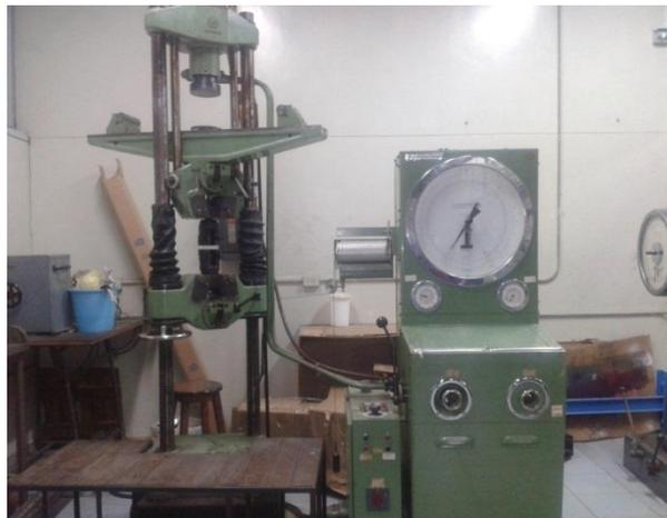
**Figura 2.31.** Máquina de ensayo universal LOSENHAUSEN.
