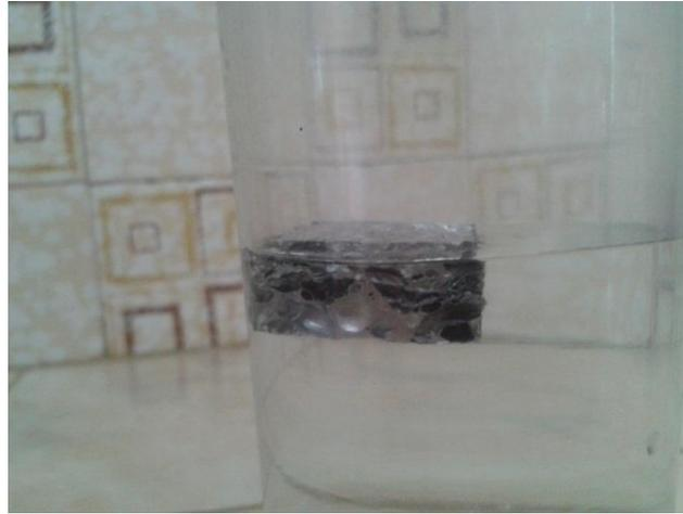
**Figura 4.10.** Probeta sin ensayar tipo Cymat, flotando en el líquido.
