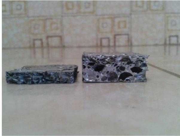
**Figura 4.13.** Comparación entre dos probetas prismáticas de Cymat: una sin ensayar (der) y la otra después de haber sido ensayada (izq).
