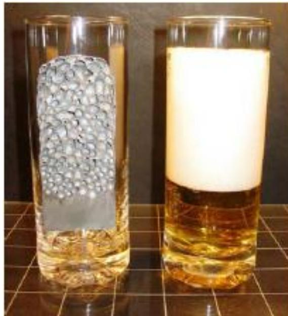
**Figura 2.7.** Comparación entre una espuma metálica formada por inyección de gas y un vaso de cerveza con espuma (Babcsán Y Banhart, 2006).
