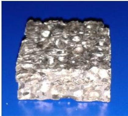
**Figura 3.2.** Probeta prismática de espuma de aluminio, tipo Cymat.
