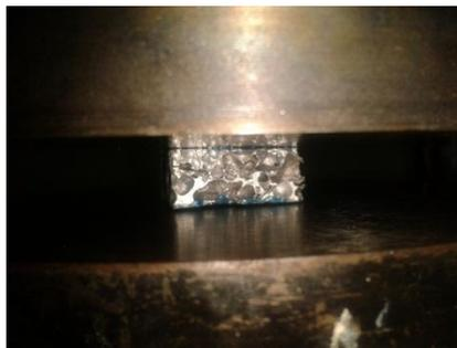
**Figura 3.3.** Posición de las probetas entre los cabezales de la máquina.
