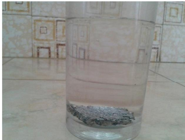
**Figura 4.11.** Probeta ensayada tipo Cymat, sumergida en el líquido.
