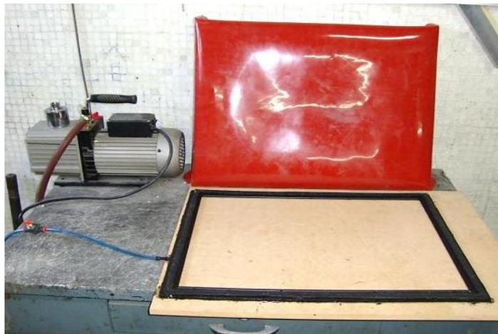
**Figura 5.4.** Elementos empleados para el proceso de vacío.
