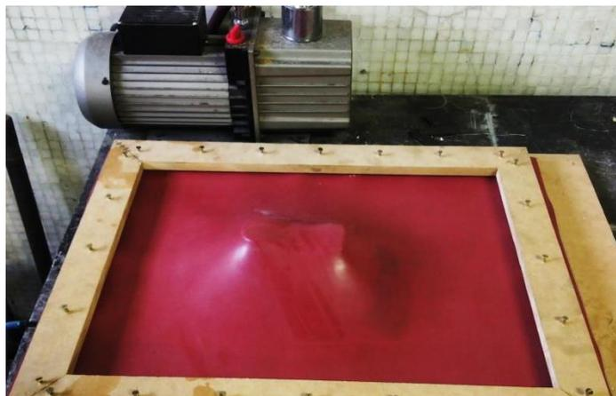
**Figura 5.5.** Visualización del proceso de vacío.
