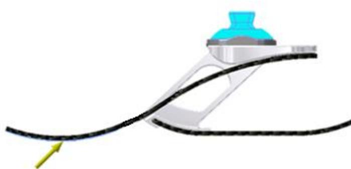
**Figura 4.3.** Parámetros de sujeción y aplicación de la carga durante los análisis computacionales.
