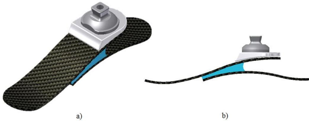
**Figura 4.7.**Propuesta de diseño de pie protésico N° 2. a) Vista isométrica. b) Vista lateral.
