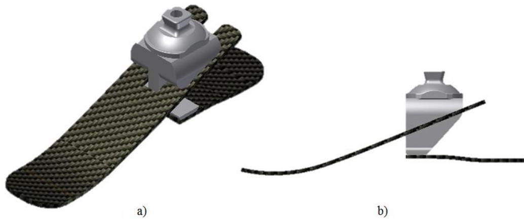
**Figura 4.9.**Propuesta de diseño de pie protésico N° 4. a) Vista isométrica. b) Vista lateral.
