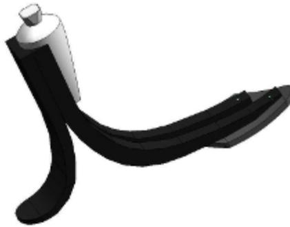
**Figura 1.1.** Vista isométrica de la prótesis. (Carrillo C. et. al., 2007)
