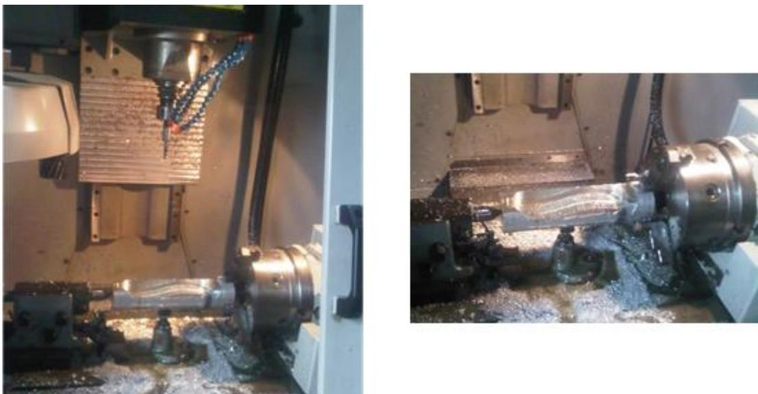
**Figura 5.2.** Mecanizado CNC del molde para el conformado de la quilla anterior.
