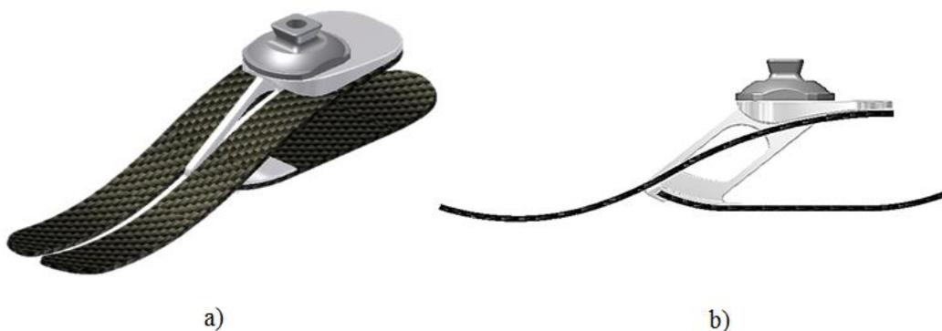
**Figura 4.6.** Propuesta de diseño de pie protésico N° 1. a) Vista isométrica. b) Vista lateral.
