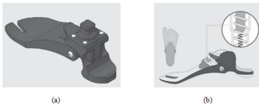
**Figura 1. 3.**(a) Diseño final para la prótesis de pie. (b) Boceto de la prótesis.
