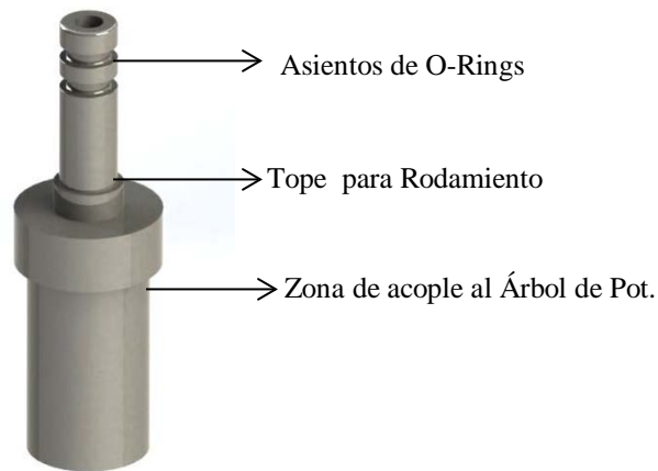
Figura 4.16. Pieza móvil o giratoria de la junta rotativa.
