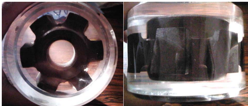
Figura 4.1. Rotor estándar para inyección de gases en fundiciones de aluminio.
