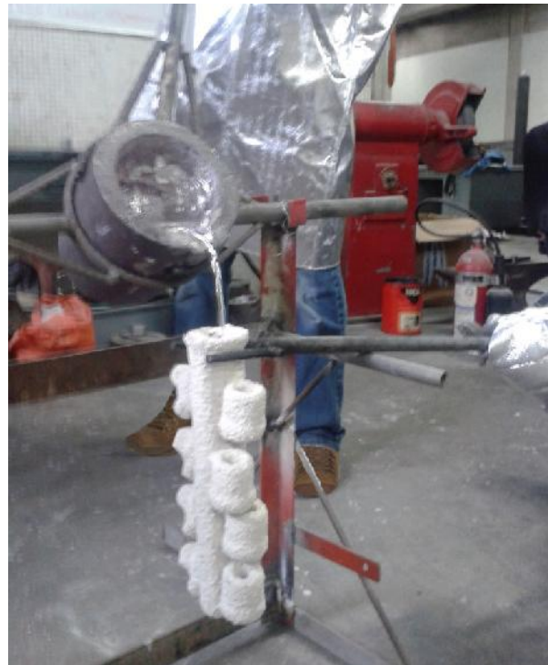
Figura 4.9 Vaciado de aluminio en moldes
