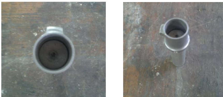
Figura 4.14 Vistas de utillaje utilizado para mecanizado de adaptador ajustable
