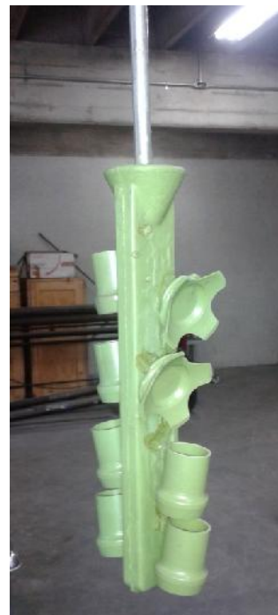
Figura 4.7 Construcción de árbol de cera (izq.) y árbol finalizado (dcha.)
