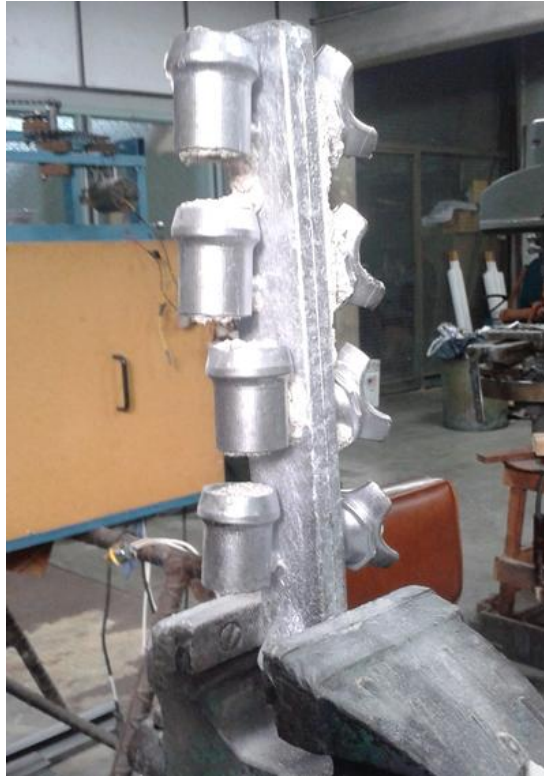
Figura 4.10 Fundición ruptura del molde
