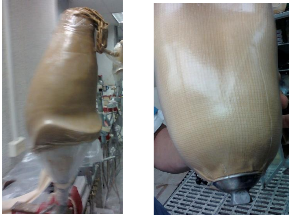
Figura 4.3 Fabricación de cuenca sobre plato de succión (izq.) y modelo de cuenca por laminación (dcha.)
