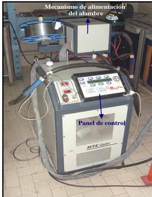
Figura 3.7.- Fuente de soldadura MTE DIGITEC 450.
