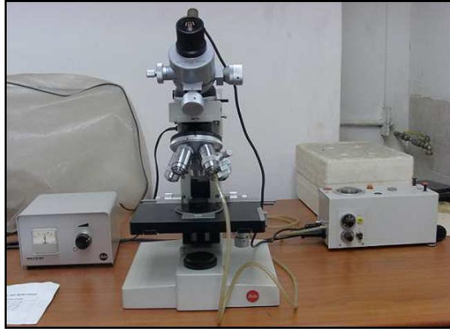
Figura 3.19.- Microdurometro marca Leitz modelo Metallux.
