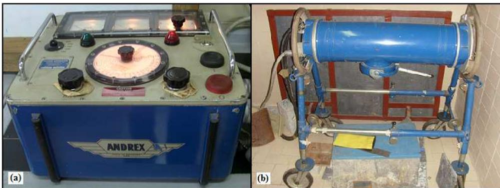
Figura 3.12.- Equipo de rayos X marca Andrex. A) mando de control. B) maquina de rayos X.
