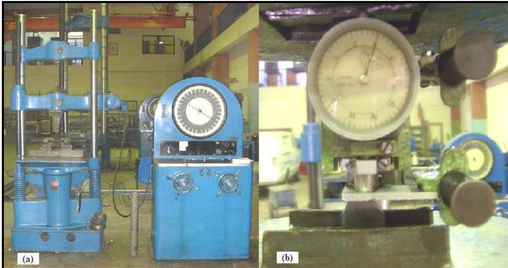
Figura 3.6.- a) Máquina universal de ensayos marca BALDWIN. b) Extensómetro marca AMSLER.
