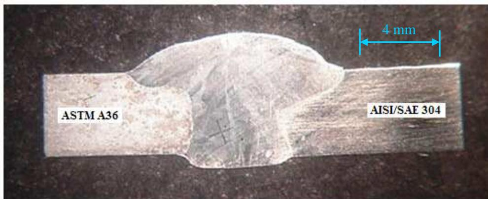
Figura 4.45.- Macrografía tomada a la sección transversal del cordón de soldadura.
