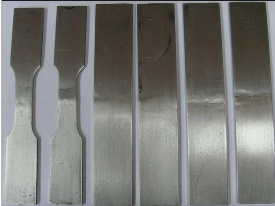
Figura 3.24.- Probetas de Tracción y dobléz utilizadas en la calificación de la soldadura.
