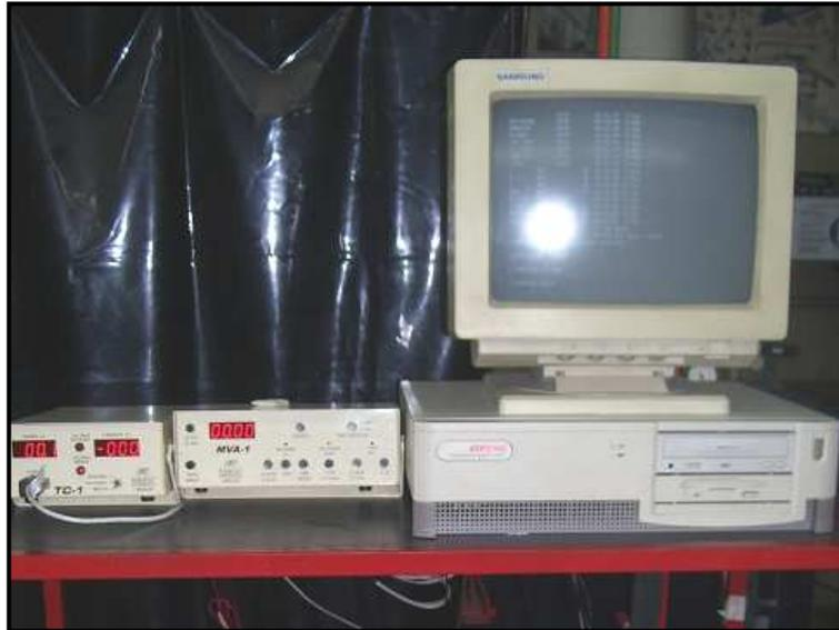
Figura 3.8.- Periféricos TC-1 (izquierda), MVA-1 (centro) y ordenador marca Compaq utilizados en la recolección de la data del proceso de soldadura.
