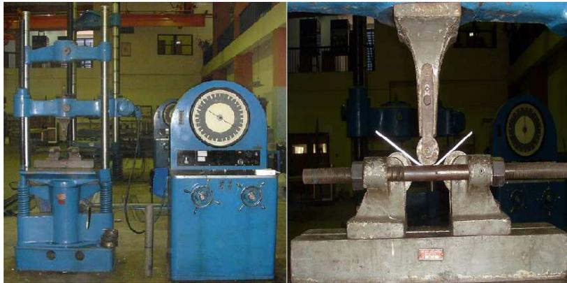
Figura 3.21.- a) Máquina universal de ensayos marca BALDWIN. b) Dispositivo de doblado marca TINIUS OLSEN.
