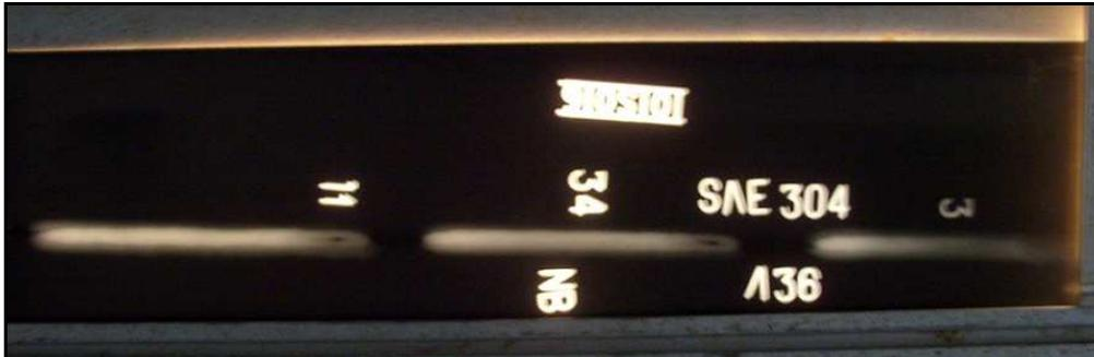
Figura 4.38.- Radiografía tomada a los tres cordones depositados sobre junta disímil.
