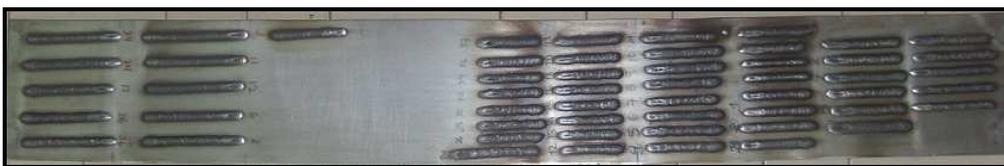
Figura 3.10.- Aspecto general de los depósitos de soldadura correspondientes a los ensayos del acotamiento final de la zona paramétrica.
