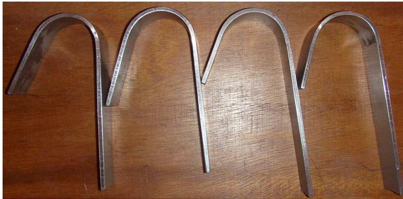
Figura 4.49.- Vista lateral de las probetas de doblez después de ser ensayadas, la parte superior corresponde al acero estructural ASTM A36.
