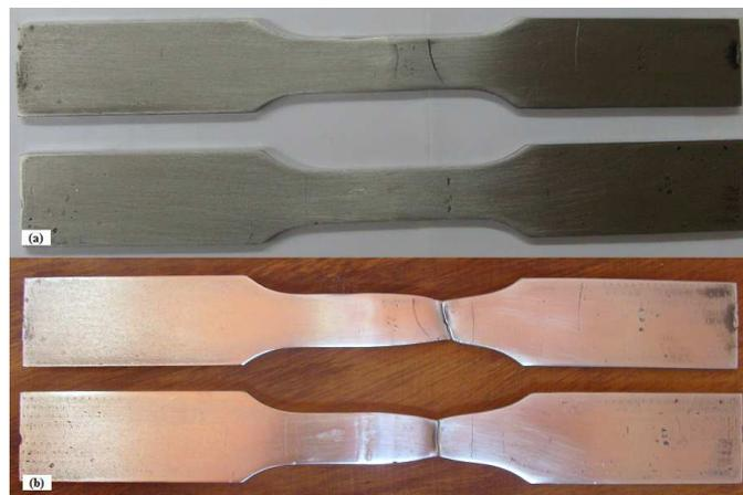
Figura 4.52.- a) Probetas de tracción antes de ser ensayadas. b) Probetas de tracción después de ser ensayadas. En ambos casos, lado izquierdo acero AISI/SAE 304, lado derecho ASTM A36.
