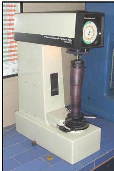
Figura 3.4.- Durómetro Wilson / Rockwell.
