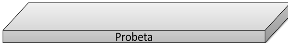
Fig. 25. Esquema de probeta plana utilizada para realizar los ensayos de conductividad.
