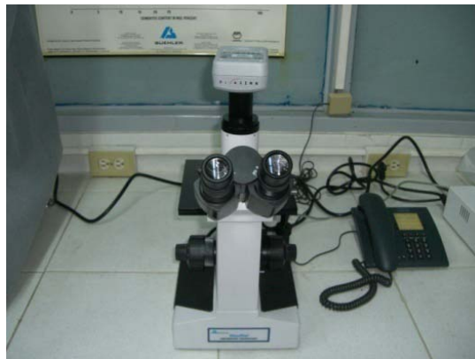
Fig. 37. Microscopio Viewmet marca Buehler, Camara Megapixel Firewire marca Pixelink.
