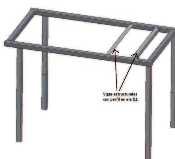
Fig. 3.26. Armadura de la mesa.
