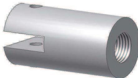
Fig. 3.10. Sujetador de la celda de carga.
