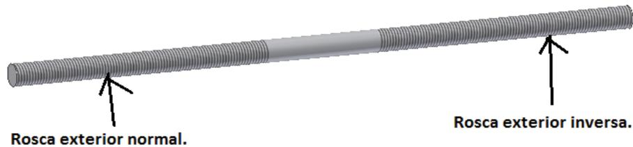
Fig. 3.18. Perno de separación.
