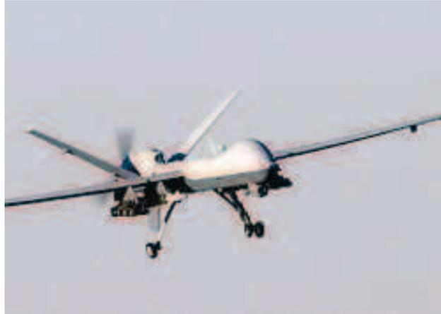
Fig. 1.6 Un MQ-9 Reaper, un UAV con capacidad de ataque con misiles y con un motor reciproco trasero como sistema de propulsión.
