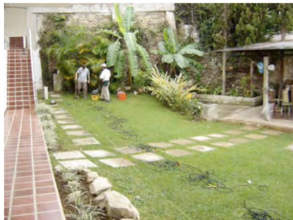
Fig. 1 Ejemplo de adquisición sísmica en el jardín de una casa con problemas de inestabilidad del terreno. En este caso la geometría de adquisición estuvo condicionada por el espacio disponible para colocar el tendido. (Foto del Archivo del Departamento de Geofísica-UCV).
