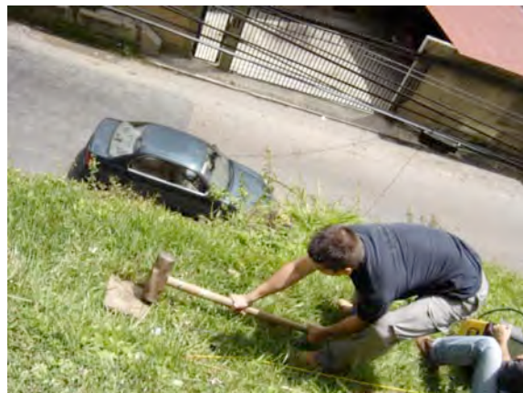
Fig. 2 Ejemplo de adquisición sísmica en una zona de topografía difícil. El sondeo fue dispuesto de forma tal de minimizar la afectación sobre la sísmica por cambios abruptos de pendiente. (Foto del Archivo del Departamento de Geofísica-UCV).
