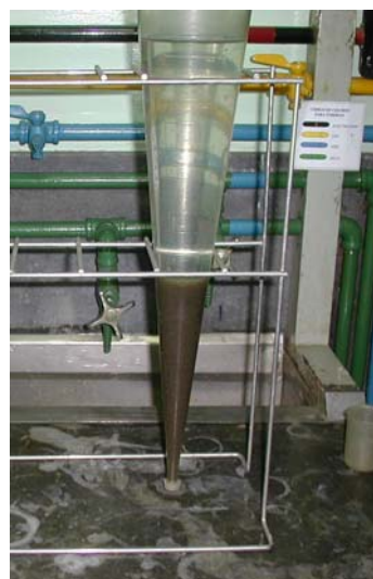
FIGURA 50.- Aspecto del lodo sedimentado a los 5 días de operación continua
