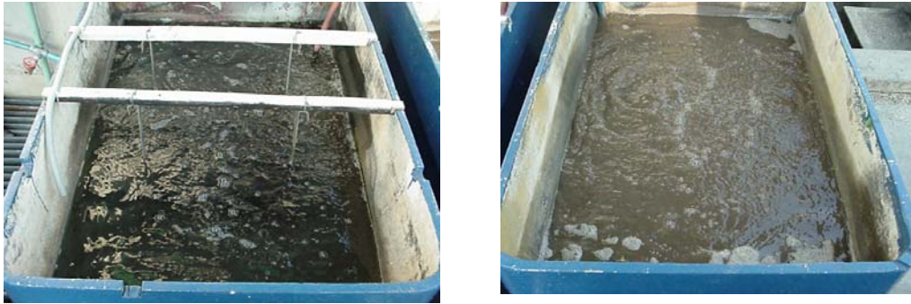
FIGURA 44.- Aspecto de ambos tanques el día de inicio de la operación continua. Híbrido (izquierda) lodos activados (derecha)
