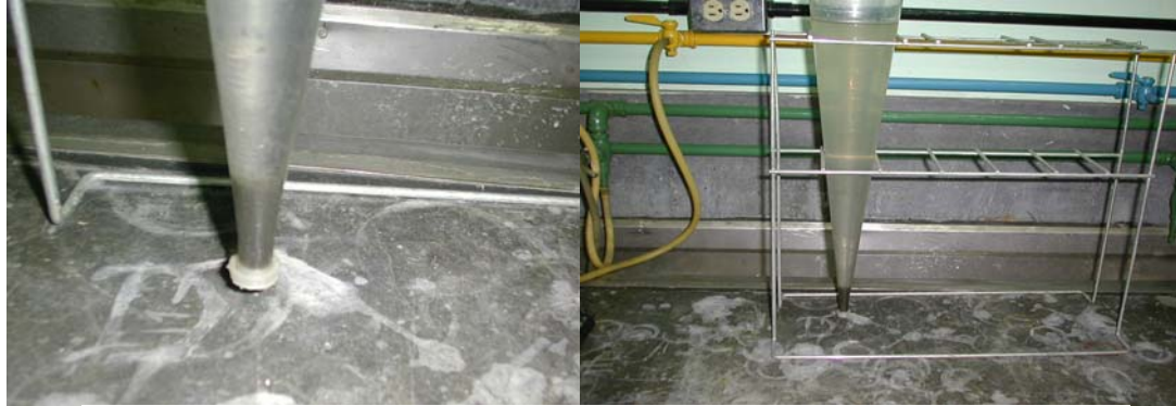
FIGURA 71.- Aspecto de los sólidos en el efluente en el sistema de lodos activados
