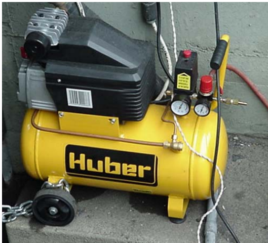
FIGURA 18: Compresores empleados en la evaluación: el amarillo corresponde al lodo activado y el gris al sistema híbrido.
