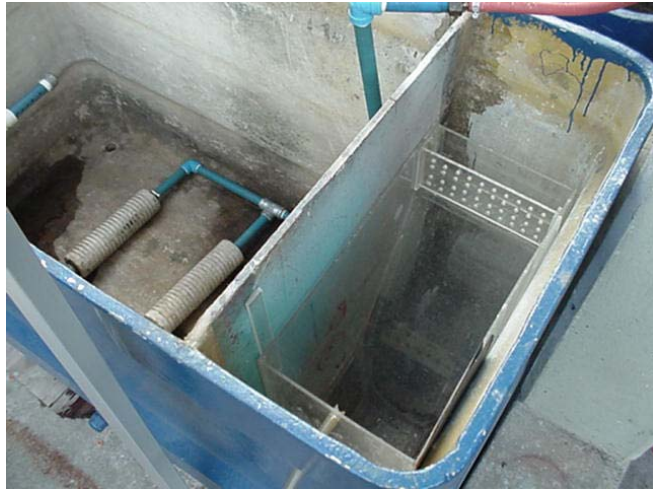
Figura 16: Disposición del sedimentador dentro del tanque. En el plano del fondo se observan los difusores.
