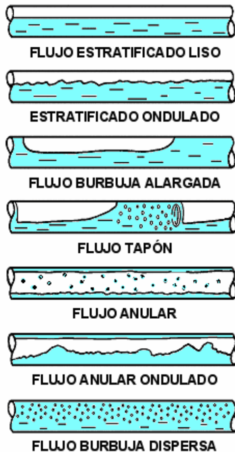
Figura ( 4): Patrones de flujo en tuberías horizontales
