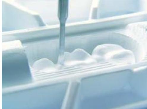
Gráfico 9 Fresado de estructura de zirconio, Sistema Lava . Tomado de [www.3mespe.com/es](http://www.3mespe.com/es), 2007
