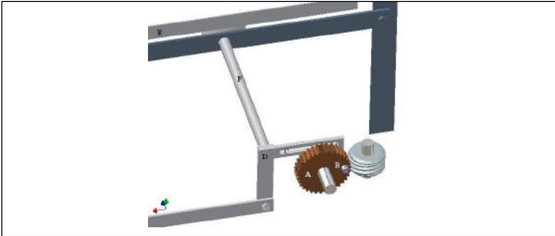
El engrane (A) tiene un pasador (B) colocado excéntricamente con respecto a su eje, de manera que al girar el engrane, el pasador desliza en una corredera (C) formada en una barra (D), que está vinculada al portabandeja guía (E) por un eje (F) soldado a este. Así que al inclinarse la barra con la corredera lo hará en igual proporción el portabandeja.
