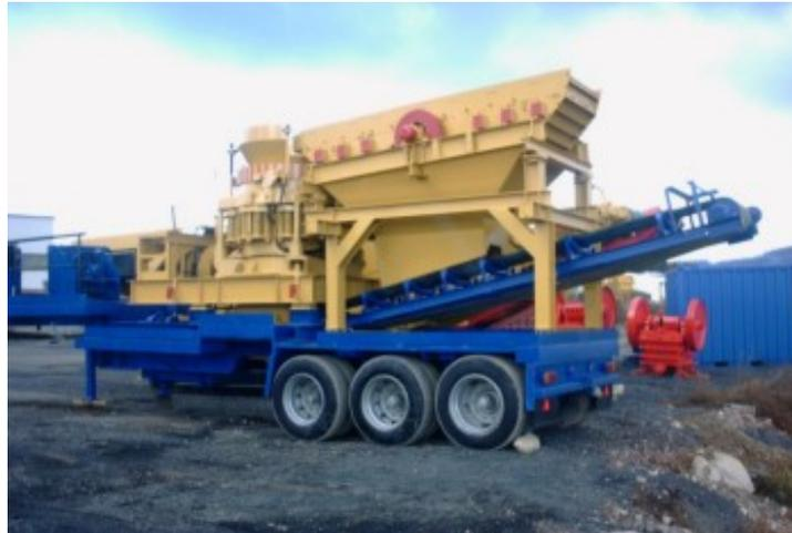
**Figura 2.30** Equipo de trituración de ENDERS & CRUSHERS & SCREENS
