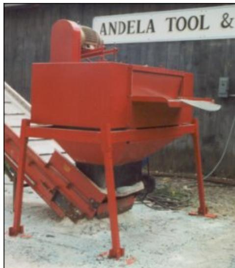
**Figura 2.31** Máquina para triturar de la compañía ANDELA
