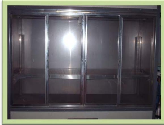
**Anexo 5** .Cámara de aplicación de plaguicidas utilizada en los experimentos de respuesta a dosis con y sin malatión.
