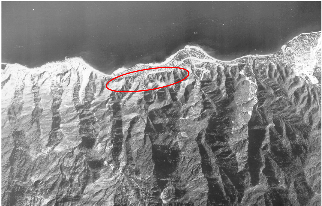
Figura 88. Foto aérea de la cuenca del Río San José de Galipán, en donde se muestra las facetas triangulares (elipse roja) como respuesta geomorfológica al sistema de fallas de San Sebastián. Foto aérea misión 3225-A, escala 50.000.
