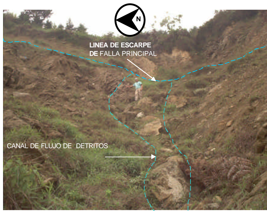
Figura 51. Movimiento rotacional simple con canal de flujo de detritos en el punto G38. La foliación de la roca madre es N70^\circ W28^\circ N y presenta además 4 familias de diaclasas. (Rumbo de la N20^\circ E ).
