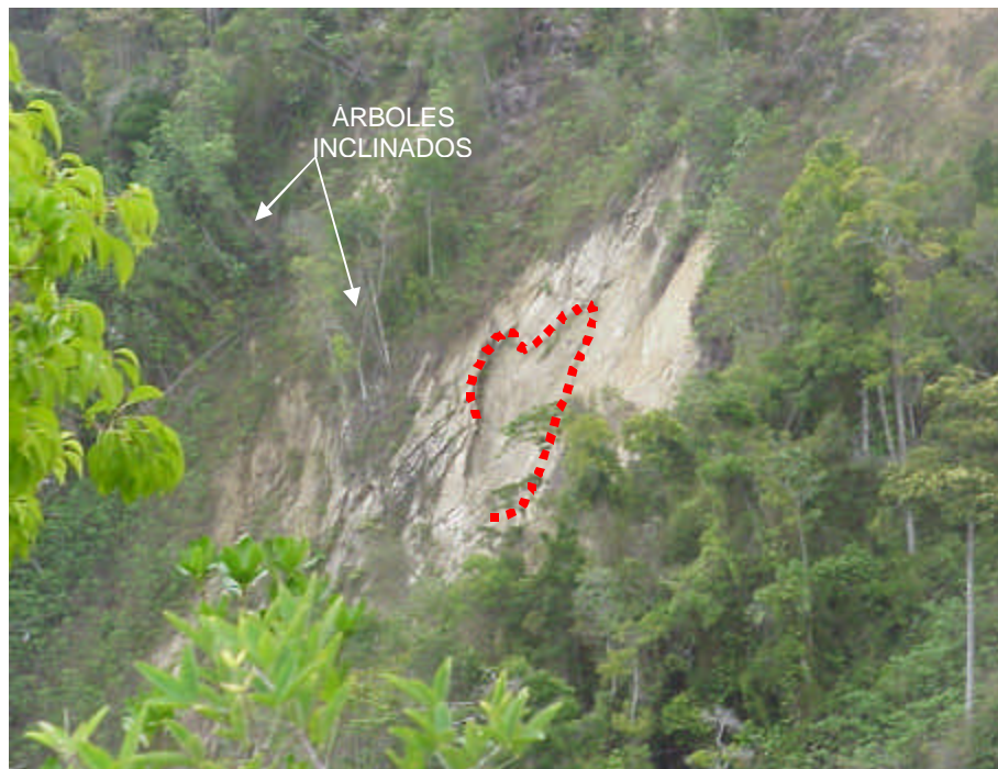
Figura 50. Deslizamiento planar ubicado en el punto LDC 12 en una ladera del límite Este de la cuenca media, vista desde Loma de Caballo con una dirección de E-W. La imagen muestra claramente la superficie limpia producto del deslizamiento del bloque planar (zona roja). La foliación de la roca es de aproximadamente N80W45N. Obsérvese la inclinación de los troncos de los árboles, evidenciando la inestabilidad de la formación y el deslizamiento en estado latente
