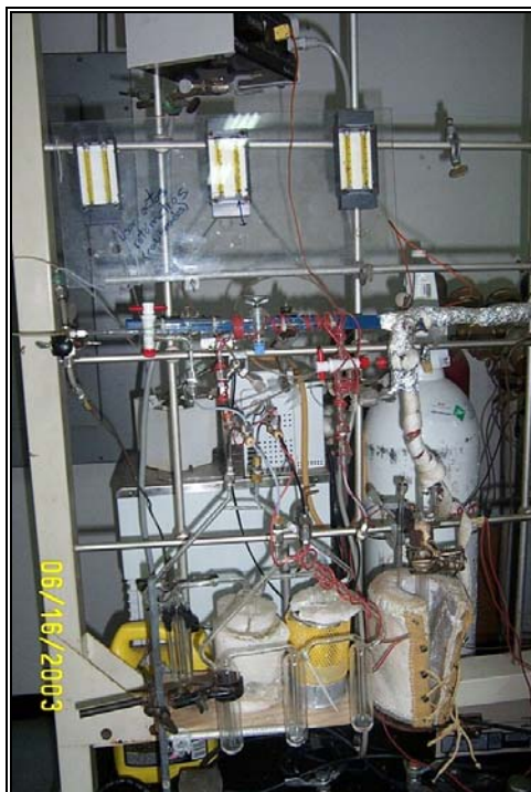
Figura N° 13. Equipo empleado en la evaluación catalítica.
