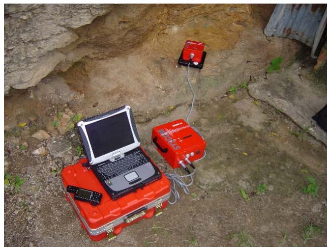
Figura 4.2.1 Disposición del equipo de medición Syscom MR2002-CE durante la adquisición
