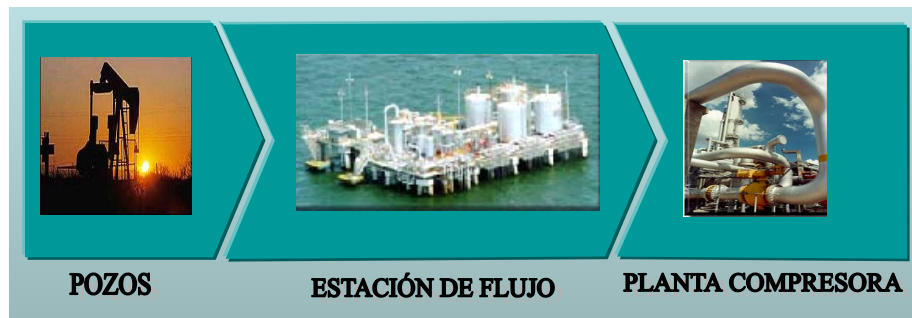
Figura 20. Sistema de recolección de gas.
