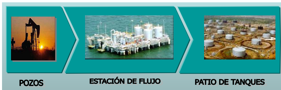
Figura 17. Sistema de recolección de petróleo.
