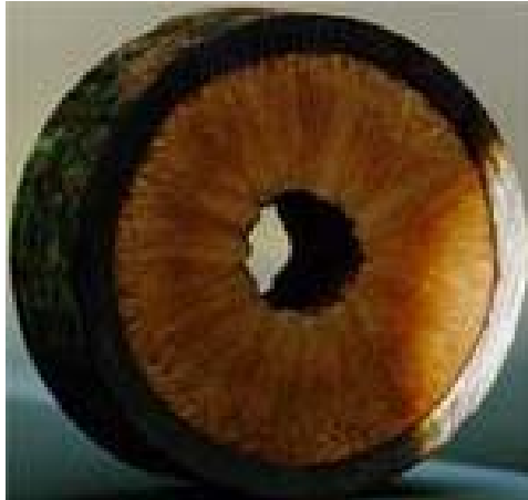
Figura 45. Deposición de escamas que obstruyen la producción del pozo y merman su potencial.
