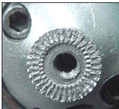
Foto 17 Deformación de los Dientes de la Corona de Estrias en Ensayo de Torsión
