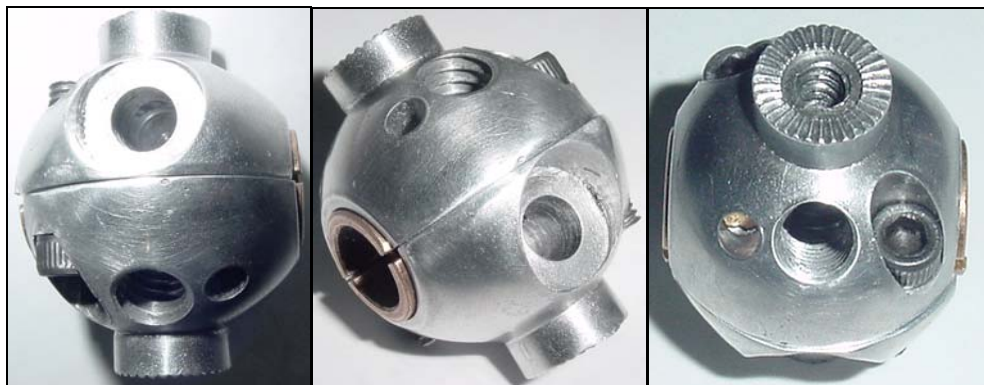
Foto 6 Rótula CS-AR obtenida por Fundición de Precisión
