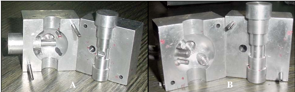
Foto 1 Moldes para Modelos en Cera A- Molde I; B-Molde II
