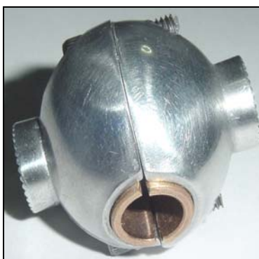
Foto 7 Rótula CS-AR obtenida por Fundición de Precisión vista lateral
