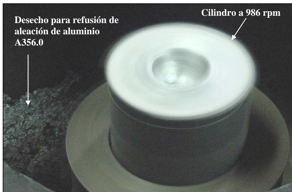
Foto 5 Centrifugación del Molde de Revestimiento
