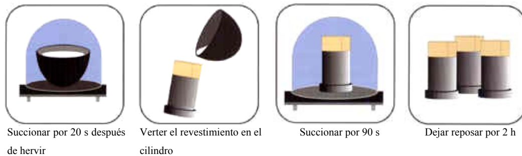
Figura 3.7 Preparación del revestimiento [24]
