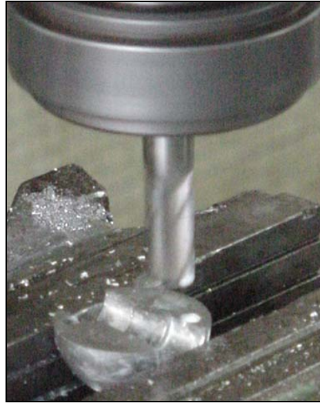
Figura 3.10 Remoción del Alimentador
