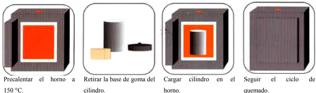
Figura 3.8 Preparación del cilindro para el ciclo de quemado [24]
