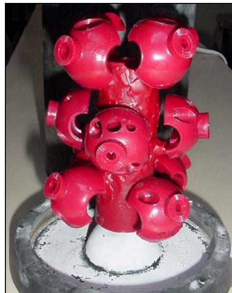
Figura 3.5 Montaje del árbol encajado en la base de goma
