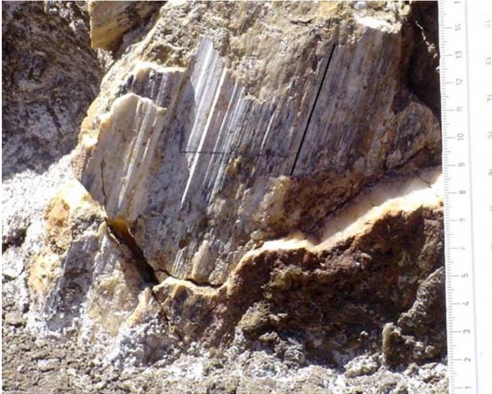
**Foto 3.12. Plano de falla con movimiento normal dextral y estrías de pitch 75° SW**
