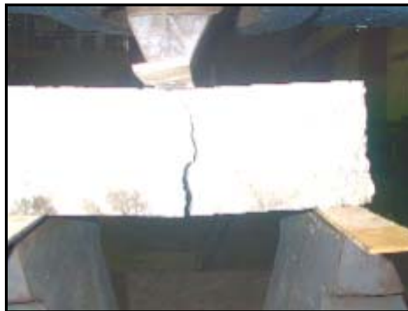
Foto II.15-A Ensayo a flexión de la viga reparada
