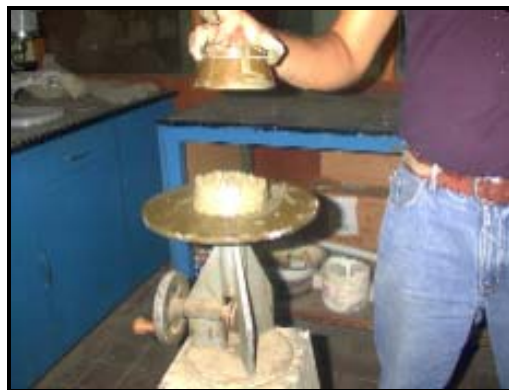
Foto II.11-A Ensayo de flujo
