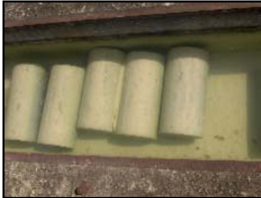
Foto II.9 Cilindros en la piscina de curado
