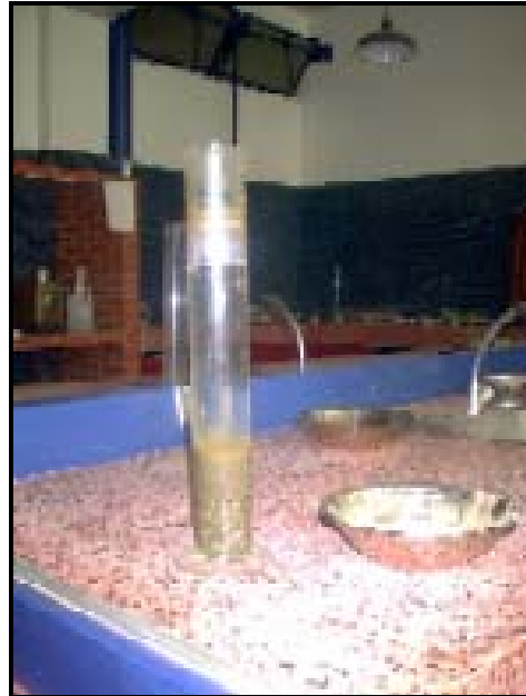
Foto II.7 Ensayo de partículas en suspensión
