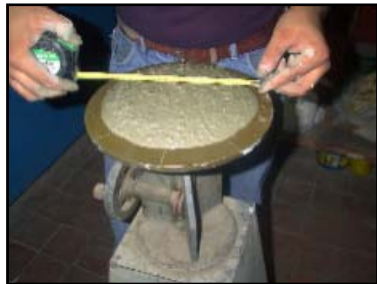
Foto II.11-C Ensayo de flujo-medidas diámetro esparcido
