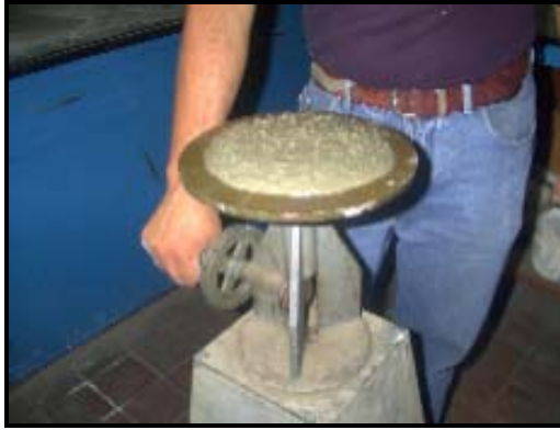
Foto II.11-B Ensayo de flujo-mesa de caidas
