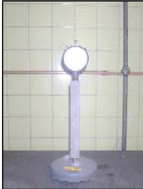
Foto II.14-E Probetas de retracción en el extensómetro.
