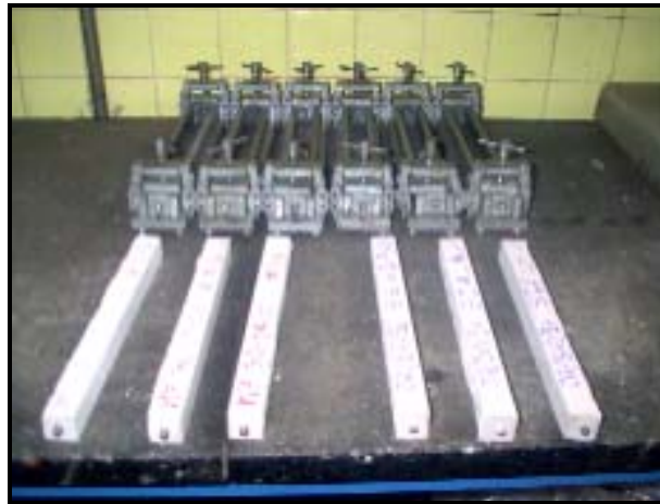
Foto II.14-C Probetas de retracción fuera del molde tipo A.L.
