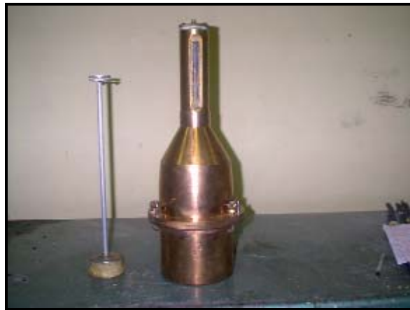
Foto II.3 Equipo para determinar el aire atrapado en la mezcla
