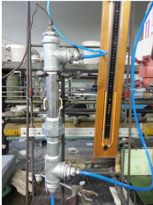
Figura N° 25: Sistema para la determinación de la caída de presión.
