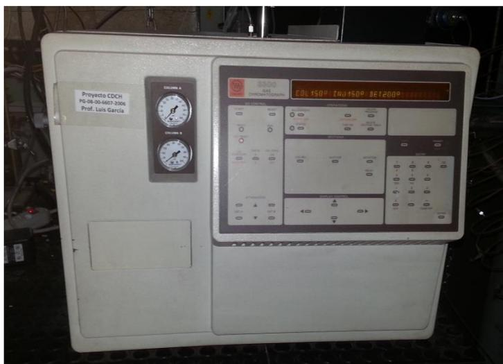
Figura N° 19: Cromatógrafo Variam 3300.
