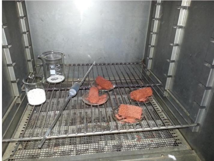
Figura N° 13: Secado de las estructuras de lodo rojo entre impregnaciones.
