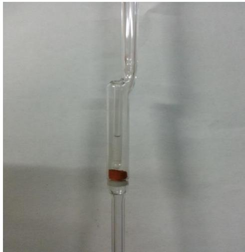
Figura N° 39: Reactor de vidrio con lodo rojo.
