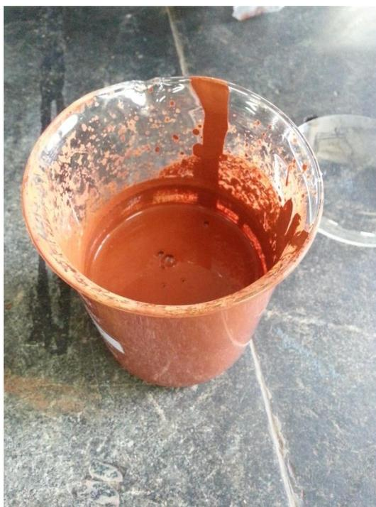
Figura N° 23: Slurry de lodo rojo luego de 24 horas de agitación.
