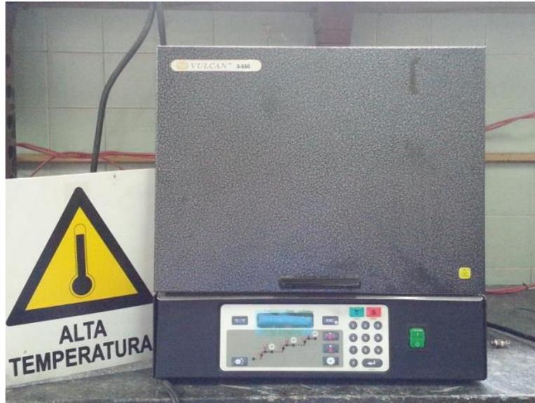
Figura N° 14: Mufla Vulcan 3-550 en la cual fueron calcinadas las estructuras.
