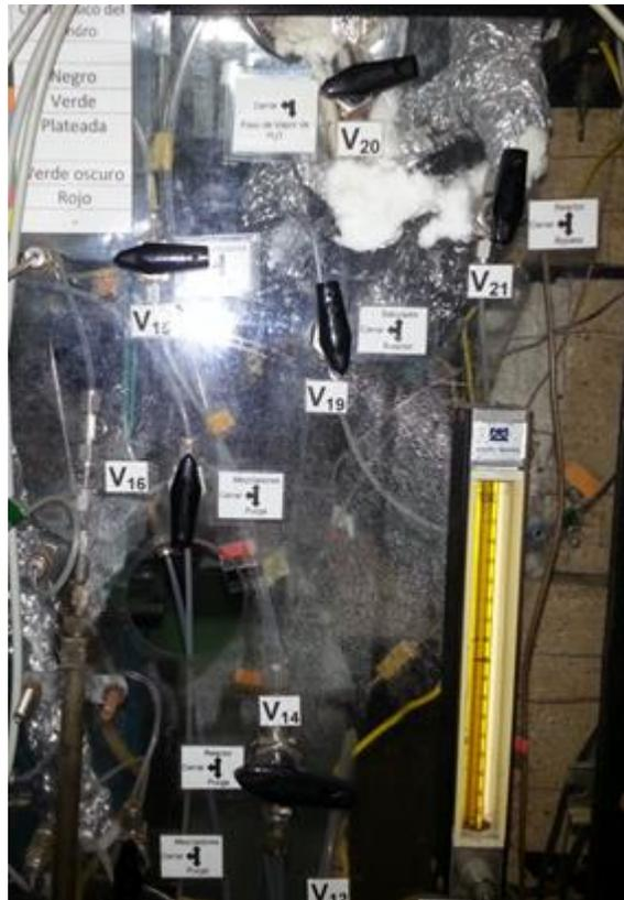
Figura N° 35 Disposición de las válvulas para obtener los moles iniciales del  $\text{CO}_2$ .
