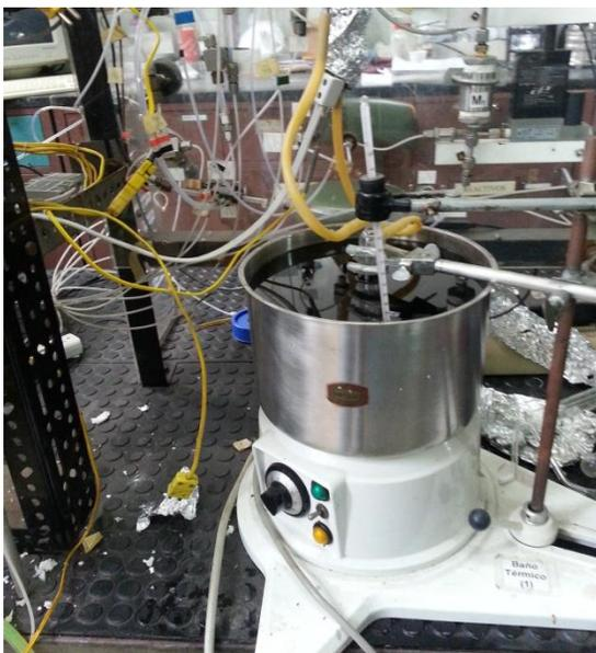
Figura N° 20: Saturador de la corriente gaseosa.
