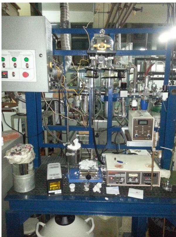
Figura N° 38: Balanza Cahn 1000.
