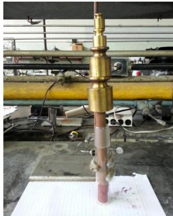
Figura N° 26: Sistema para la determinación de la resistencia mecánica.
