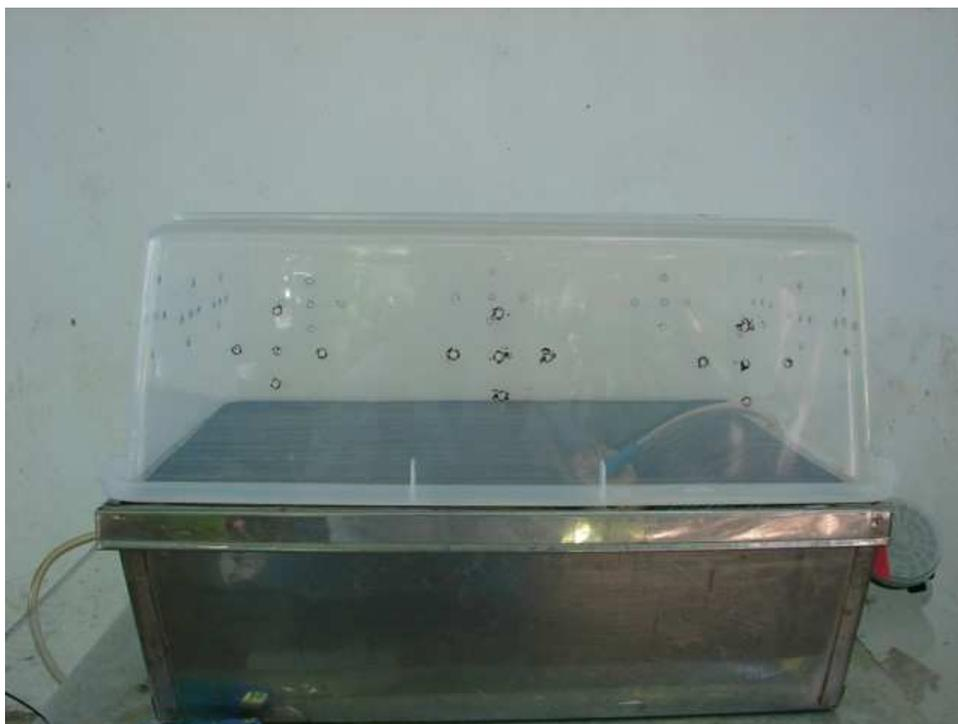
**Fig. 10. Caja Plástica con múltiples orificios laterales.**
