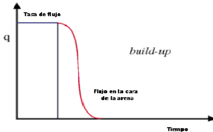
Fig.2.21 Diferencia de tasa en la cara de la arena con respecto a superficie (Tomado de Dynamic Data Analysis, Kappa)
