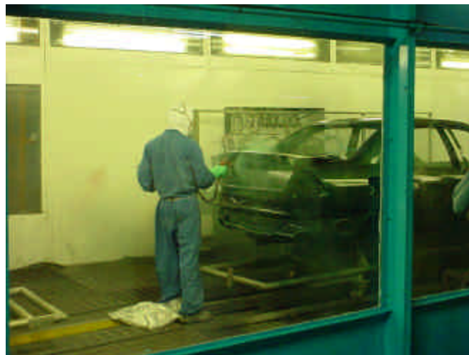
Figura N° 4.1: Proceso de pintado de los vehículos.
