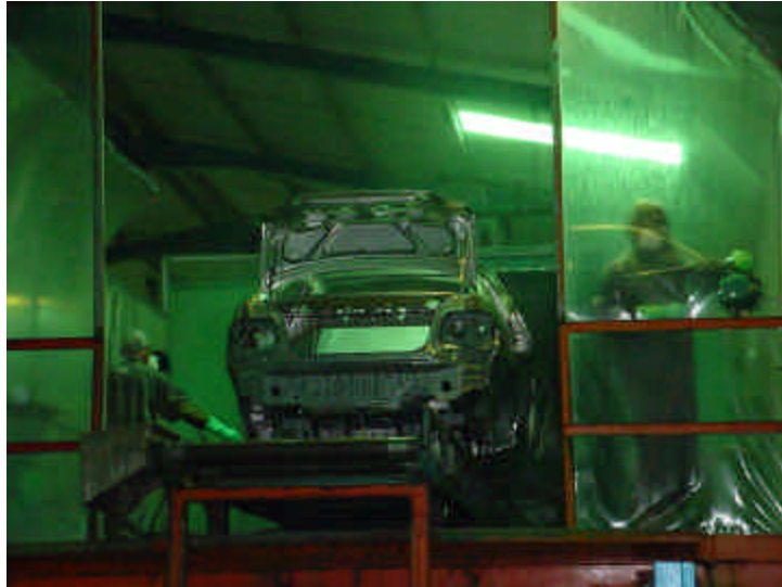
Figura N° 3.1: Aplicación del Tratamiento de fosfatizado.
