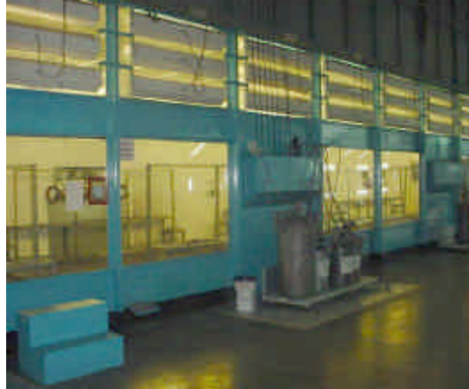
Figura N° 3.3: Cabina de esmalte
