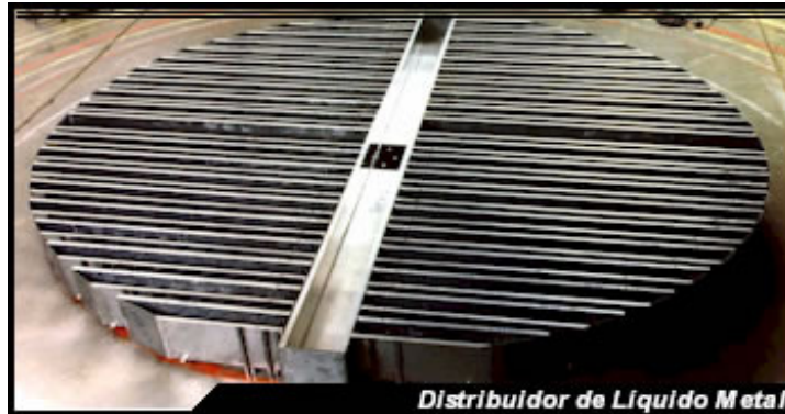
Figura 17: A) Distribuidores de bandeja perforada, B) . Distribuidores tipo vertedero elevador
