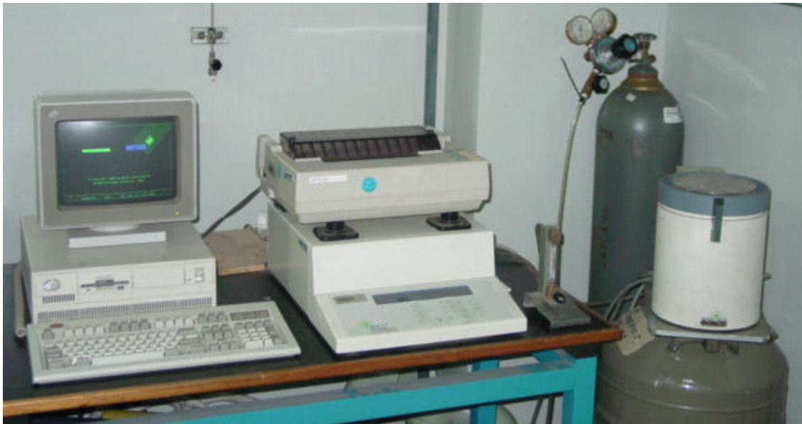
Figura 15. Equipo utilizado para realizar los ensayos de Calorimetría Diferencial de Barrido (DSC).
