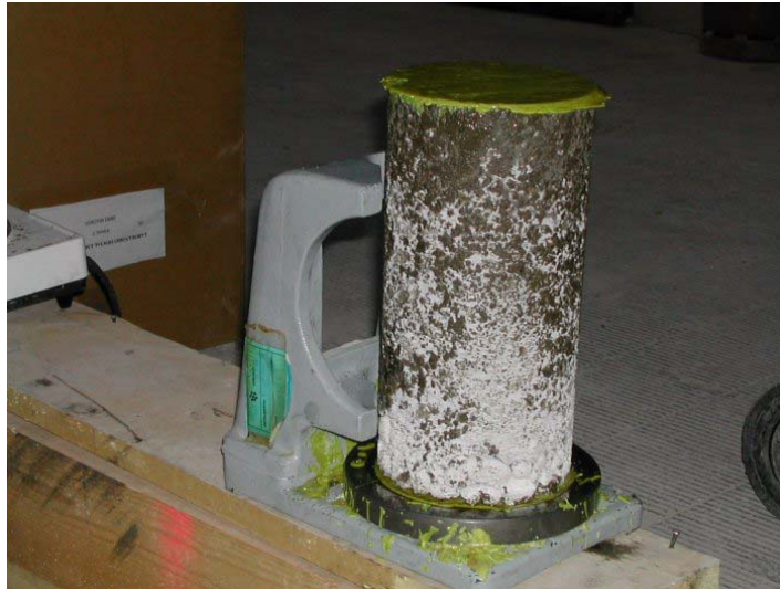
Figura 4. 3: Refrentado de las probetas
