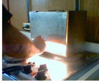
**Figura VI 44** Horno para Secar las Muestras
