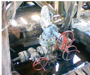
**Figura VI 49** Cabezal de Producción del Pozo ES-451
