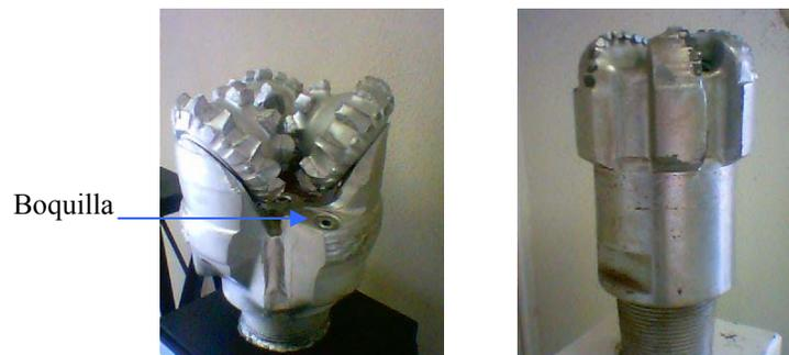
**Figura. III 14** Barrena de conos y Barrena tipo Policristalina
