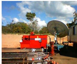
**Figura VI 62** Antena de Telecomunicaciones del Taladro Corpoven-10
