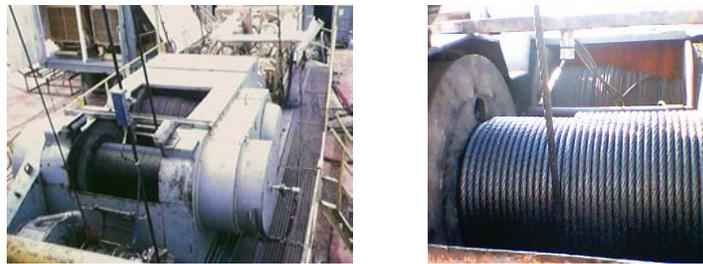
**Figura. III 5.** Ejemplo de un tipo de malacate de perforación y su carrete.
