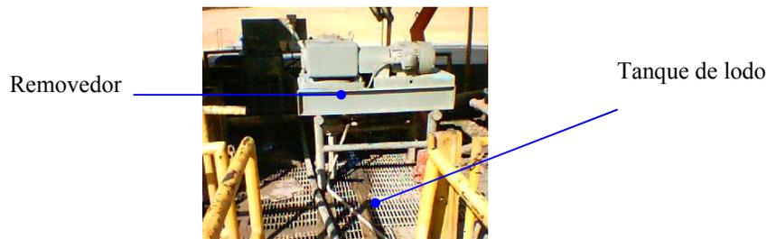
**Figura. III 27** Tanque de lodo y removedores
