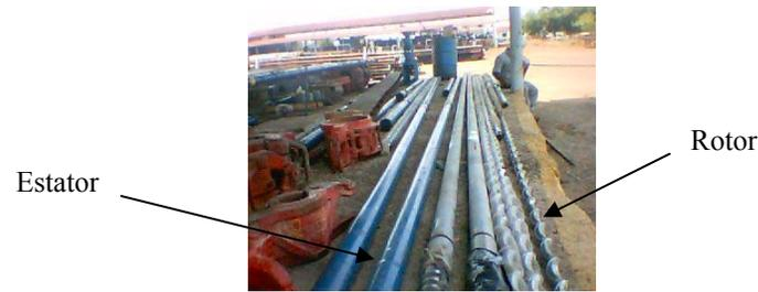
**Figura III 40** Bomba de Cavidad Progresiva (BCP)
