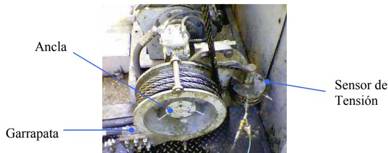
**Figura III 8** Ancla, Garrapata y Medidor de Tensión
