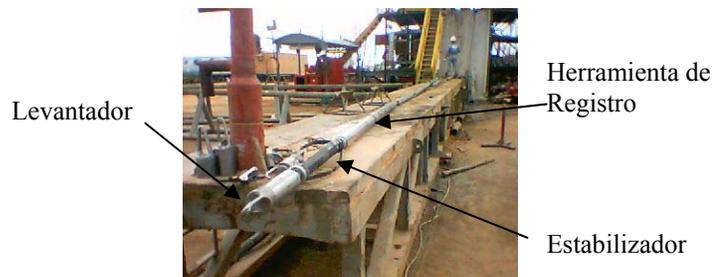
**Figura III 50** Ensamblaje de la Herramienta de Registro Eléctrico
