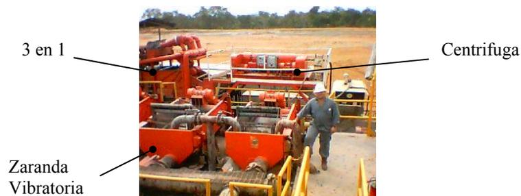
**Figura VI 33** Sistema de Control de Sólidos del CPV-10
