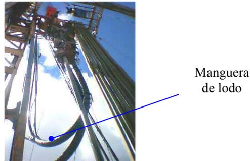
**Figura. III 24** Manguera Rotatoria o de Lodo
