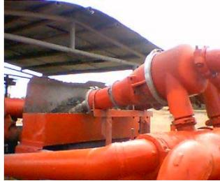
Figura. III 33 Desarenador
