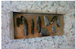
**Figura VI 34** Muestras de Canal del Pozo ES-451
