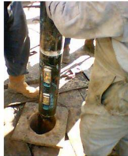
**Figura VI 28** Ampliador Doble de Cuchillas
