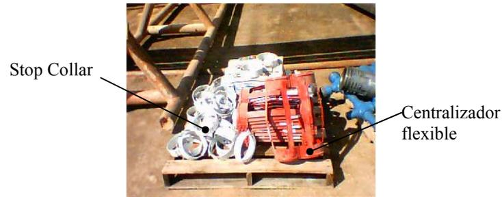
**Figura VI 10** Centralizadores Flexibles
