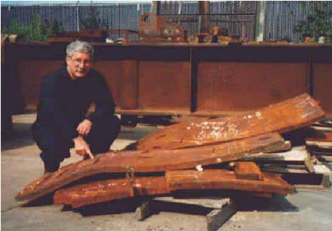
Figura 11. Secciones del casco removidas de un recipiente de coquización abombado.
