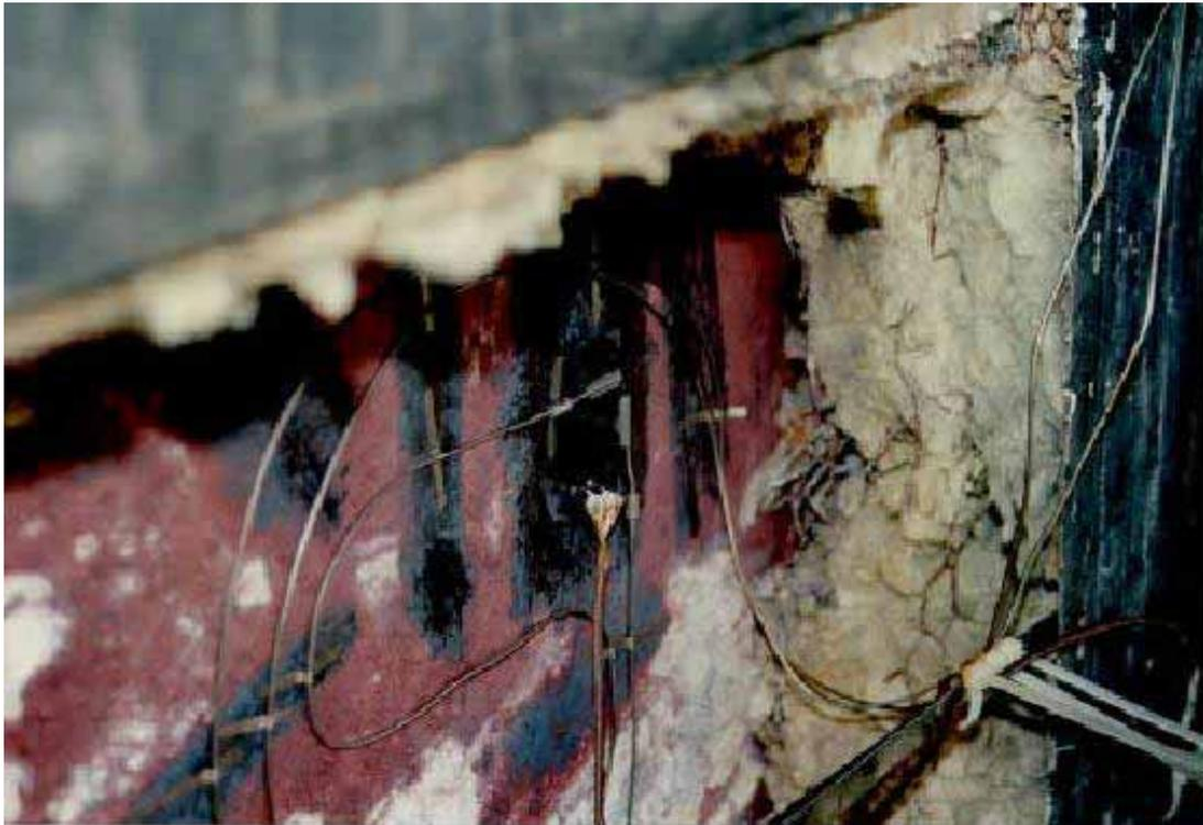
Figura 16. Galga extensiométrica axial y circunferencial instalada en un recipiente de coquización. El aislante es removido durante la operación.
