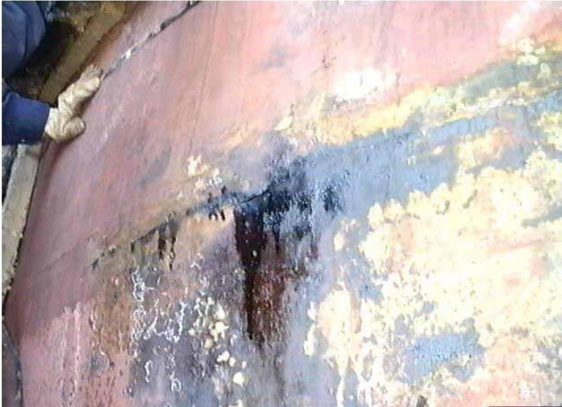
Figura 15. Grieta detectada en un tambor de 27 pies durante su llenado con crudo caliente.
